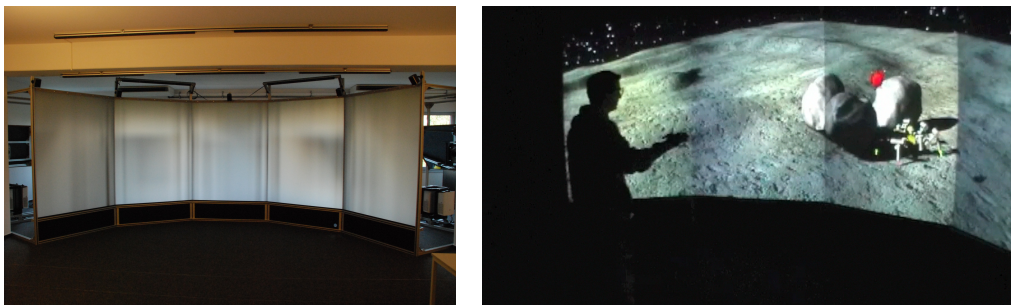
Abbildung 3: Links: CAVE-System in der ersten Ausbaustufe mit 5 Stereoprojektionsschirmen Rechts: Interaktionsbeispiel in der CAVE
