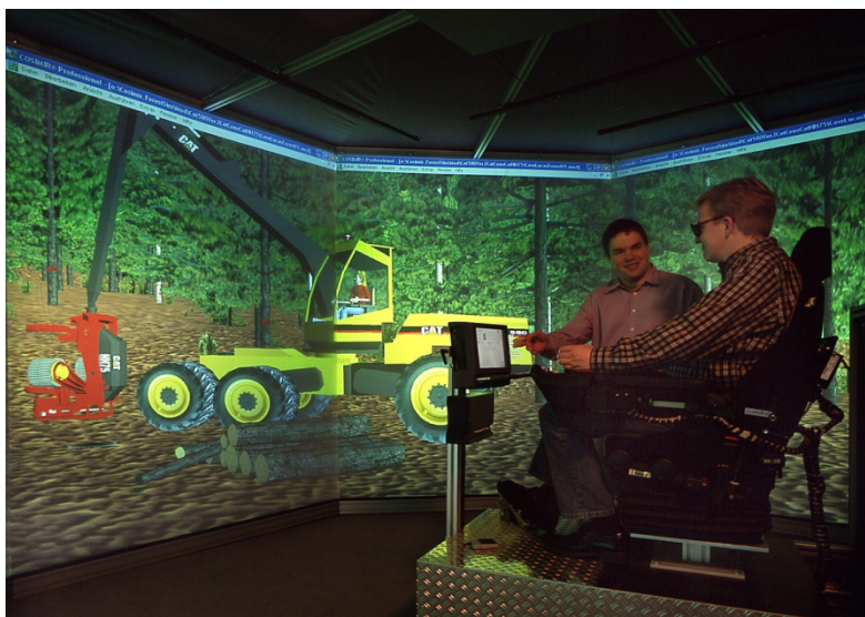
Abbildung 2: Fahrsimulation in einer Mehrschirmprojektion
