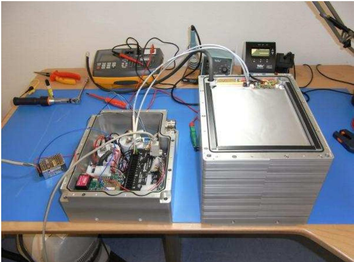
Abbildung 17 Montage der Batterie
