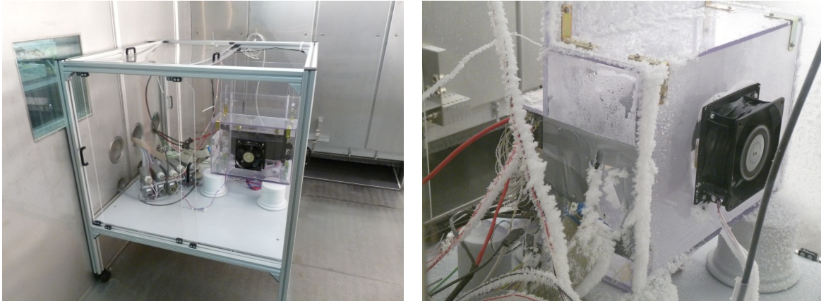
Abbildung 7: (links) Messaufbau zur Charakterisierung des FCgen-1020ACS in der Klimakammer. Um die Einflüsse der starken Luft-Verwirbelungen in der Klimakammer aufgrund des hohen Luftdurchsatzes zu unterbinden, wurde der Stack in eine Schutzbox eingehaust. (rechts) Der Stack konnte bis zu einer Temperatur von -40^{\circ}\text{C} betrieben werden, wobei sich das Produktwasser in Form von Eis an dem Gehäuse und Kabeln kristallisierte.
