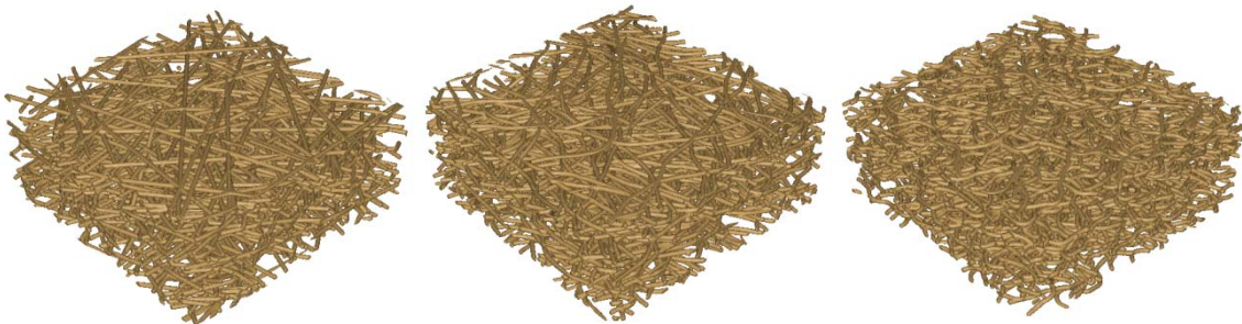
Abb. 2: Beispiele für GDL Strukturmodelle mit geraden Fasern, leicht gekrümmten Fasern und stark gekrümmten Fasern.
