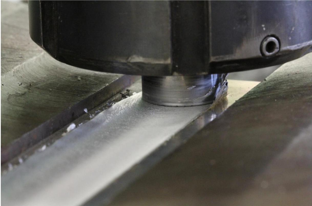
**Bild 2-25: Aluminium/Stahl-Verbindung, während des Schweißprozesses**
