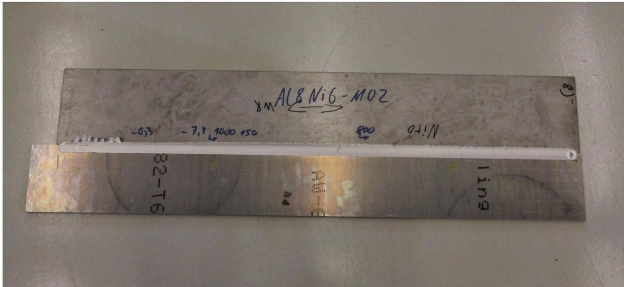
Bild 2-19: Aluminium/Stahl-Verbindung (oberhalb der Schweißnaht CrNi-Stahl)
