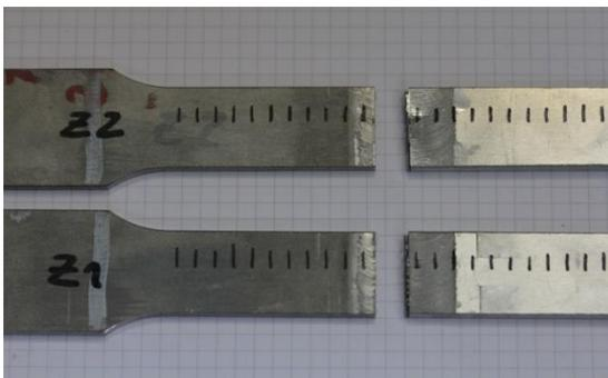
**Bild 2-7: Zugproben nach der Prüfung**
