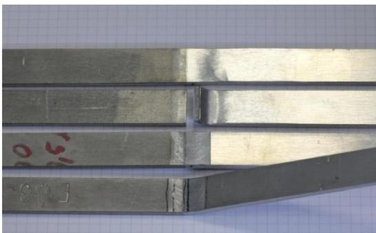
**Bild 2-9: Biegeproben über Wurzel (erste und zweite Probe von oben) und über Decklage**
