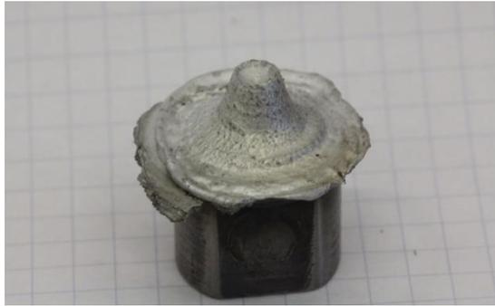
**Bild 2-4: Zerstörtes Tantal-Werkzeug**
