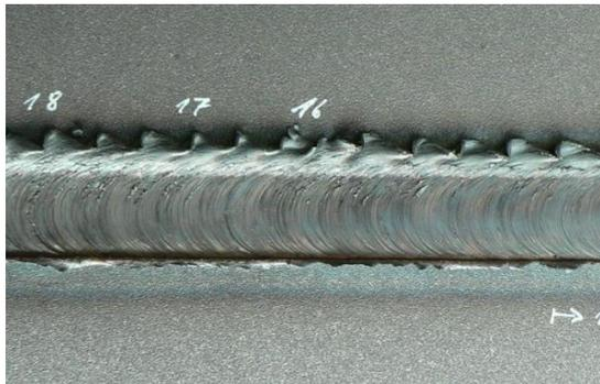
**Bild 2-2: Oberfläche einer Schweißung an 4,2 mm Schiffbaustahl mit Wolfram-Rhenium-Werkzeug**
