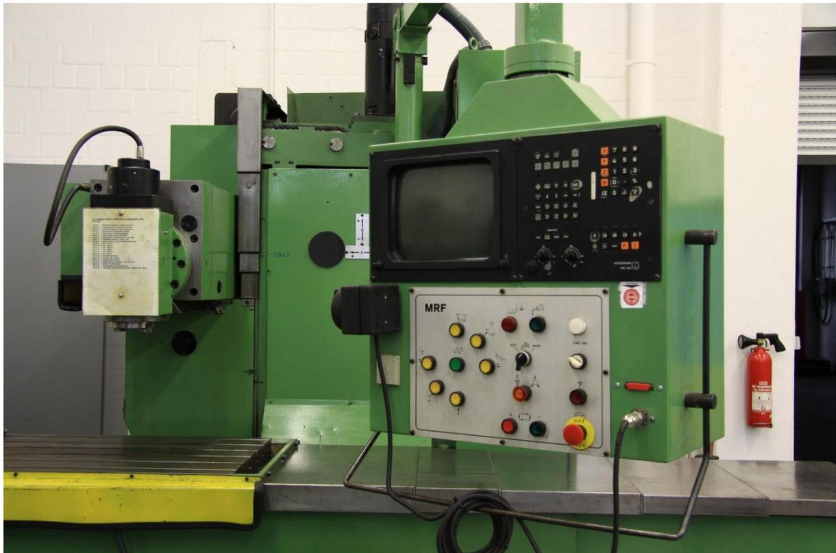
**Bild 1-2: Flachbettfräsmaschine TOLEDO M.R.F. MODELL FBF-1750**
