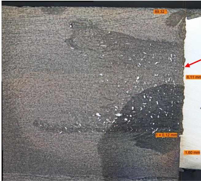
**Bild 2-15: Schliff, der helle Bereich ist CrNi-Stahl ( $t = 8 \text{ mm}$ ), ebenfalls keine scharfe Trennungslinie, deutliche Verbindungen bzw. Rührstrukturen sind erkennbar (Pfeil)**
