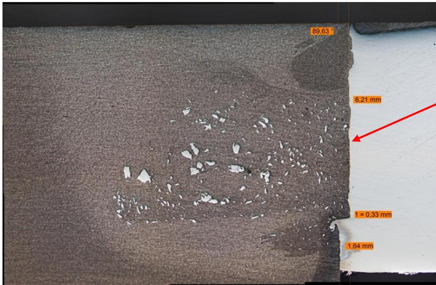
**Bild 2-17: Schliff, der helle Bereich ist CrNi-Stahl ( $t = 8 \text{ mm}$ ), ebenfalls keine scharfe Trennungslinie, deutliche Verbindungen bzw. Rührstrukturen sind erkennbar (Pfeil)**
