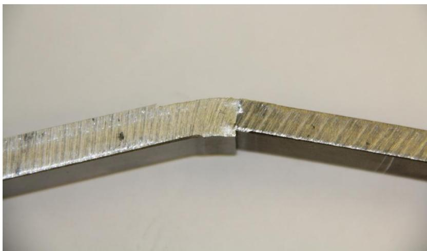
**Bild 2-18: Biegeversuch (rechts CrNi-Stahl)**
