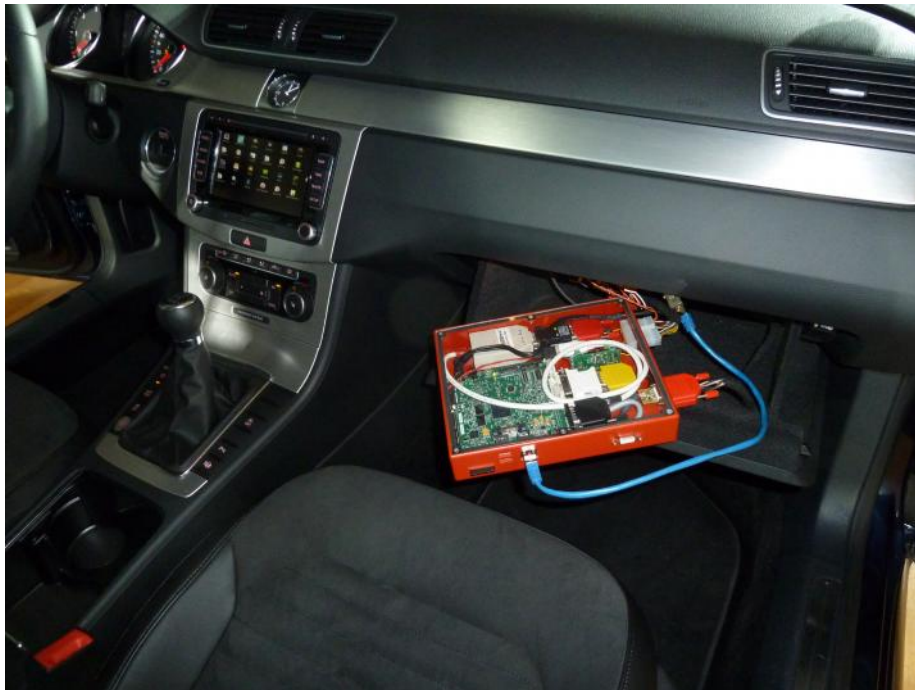
Abbildung 35: Box mit Applikationsplattform und Vertrauensanker im Handschuhfach des VW Passat
