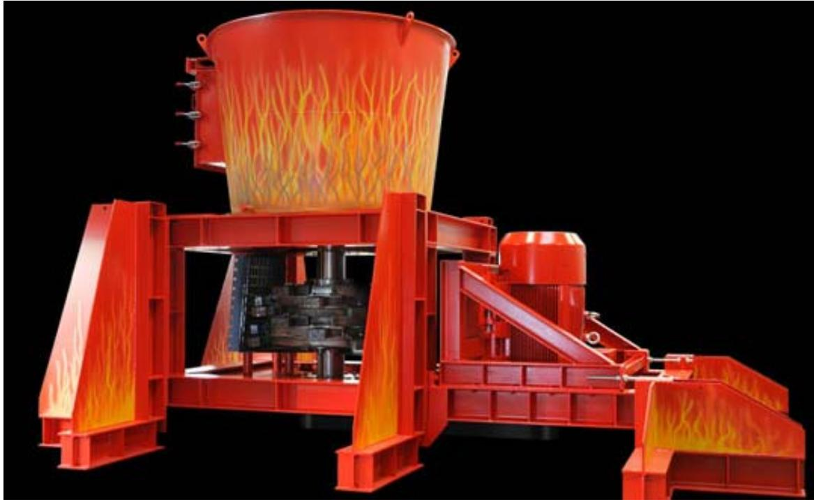
Abb. 4-4: Querstromzerspaner der Fa. Anlagenbau Umwelt + Technik (AUT) [9]
