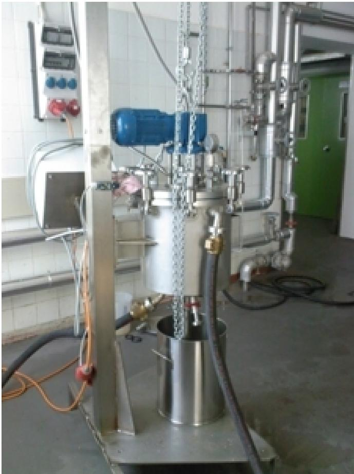
Abb. 4-15: Reaktor für Steam-explosion und Dämpfversuche
