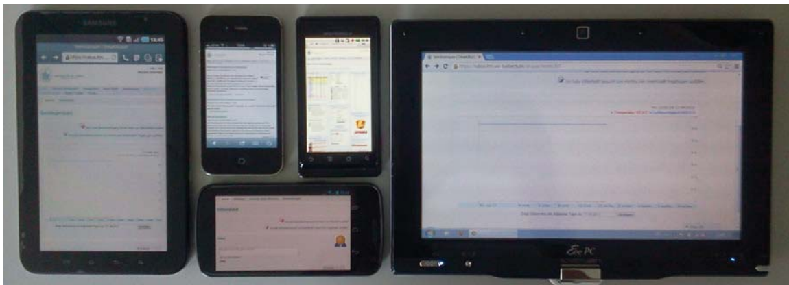
Abbildung 43: SmartAssist Portal auf unterschiedlichen Hardwareplattformen, v.l.n.r: Samsung Galaxy Tab (Android 2.3), Apple iPhone 4S (iOS 6.1), Motorola Milestone (Android 2.2), Galaxy Nexus (Android 4.2, unten), Asus EEEPC (Windows 7)
