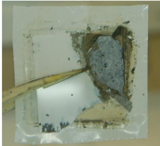
**Abb. 1:** Keramischer Ionenleiter nach dem Zyklieren zweier Lithium-Anoden. Durch Spannungen in der Pouch-Zelle entstehen Risse in der dünnen und harten Keramik.
