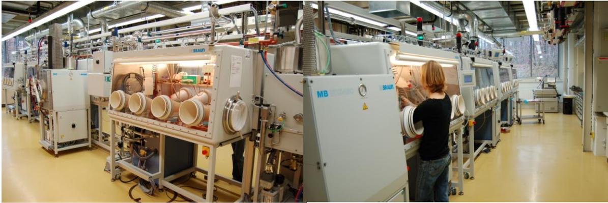
**Abb. 21:** Prozesslinie zur Herstellung von Li-S-Batterien
