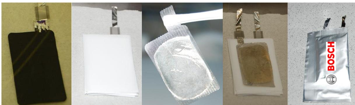
**Abb. 22:** Illustration des Aufbaus eines Pouch-Zellen-Demonstrators.
