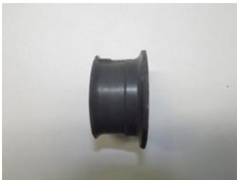
Bild 11: Elastomerfeder mit ausgerichtetem MAE-Material
