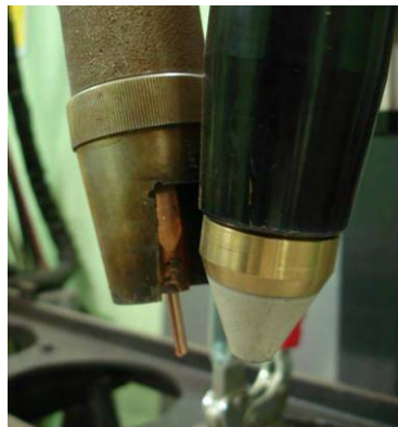
Abbildung II-7 Brenneranordnung des Plasma-UP-Hybrid-Prozesses mit beschichteter Düsenkappe( Al_2O_3 )
