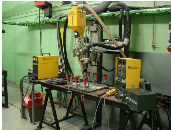
Abbildung II-5 Versuchsstand zur Erprobung des Plasma-UP-Hybrid-Schweißens
