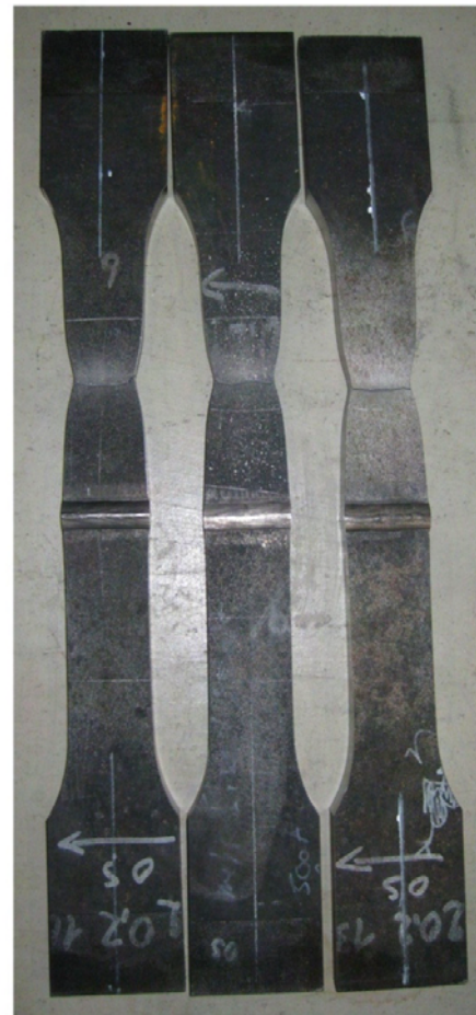
Abbildung II-27: Zugversuch; geprüfte Proben NVEBW 20.2-10, 20.2-13, 20.2-16 mit Versagen im Grundmaterial; Darstellung der Bruchflächen
