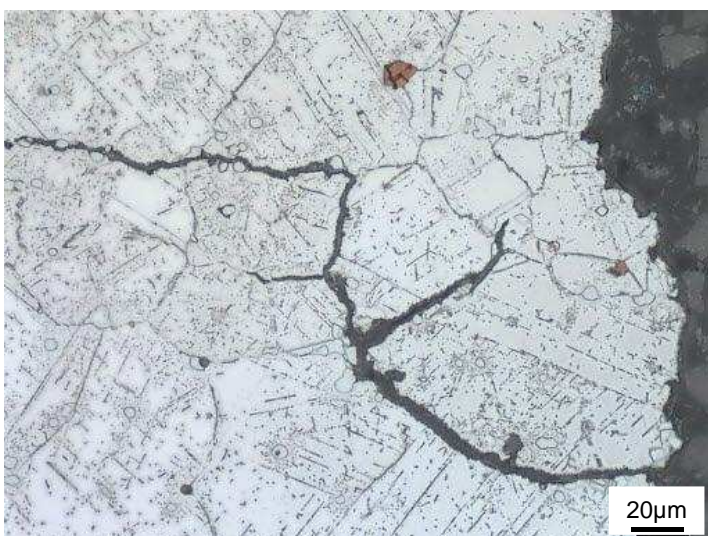
Bild 8.52 Riss von der Bruchoberfläche ausgehend, Probe tKH0d0; 800°C, 175 MPa, 418h, Werkstoff Nicrofer 6025 HT
