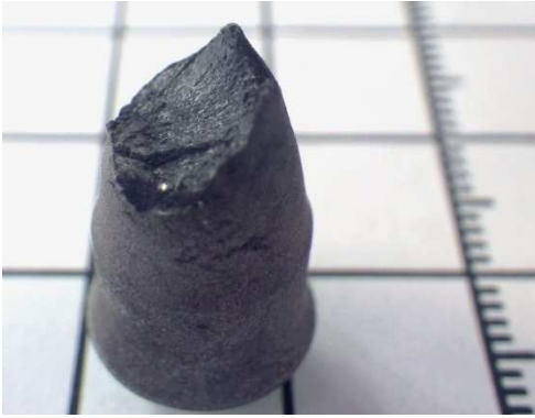
Bild 8.58 Bruchfläche, Probe tKL11d2, 1100°C, 25 MPa, 0,1 Hz, 1099h, Werkstoff Centralloy 60 HT R
