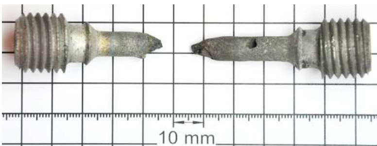
Bild 8.33 Probe tKL11zl3 (1100°C, 7,1 MPa, 14205h) nach dem Ausbau
