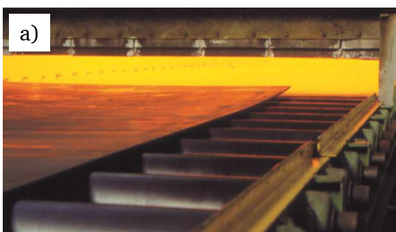
Bild 5.14 Rollenherdofen (Quelle: ThyssenKrupp VDM) (a), Skizze Ofenrolle mit stangenförmigem Glühgut (b)
