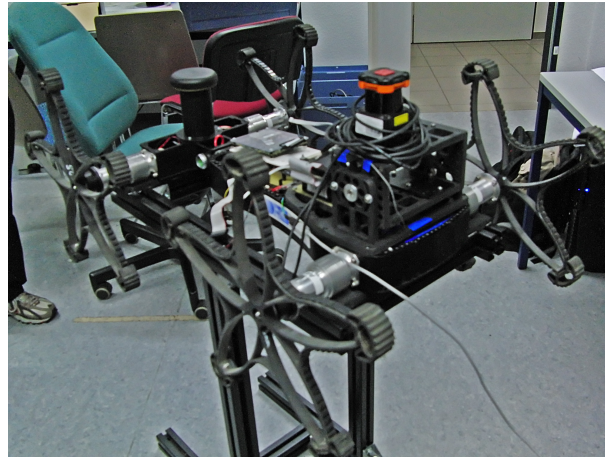
Abbildung 20: Erster Prototyp des Sensorkopfes. Dabei handelt es sich um eine feststehende Halterung für die Sensorik. Sie dient auch dazu, weitere Informationen zur möglichen Befestigung von Sensoren an der Roboterplattform zu erlangen. Sie ist die Basis für das Design des endgültigen Sensorkopfes.
