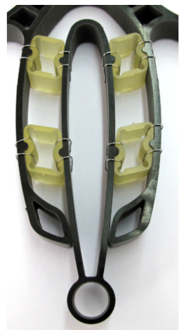
Abbildung 47: Konzepte zur Integration von Federelementen in das Asguard-Rad
