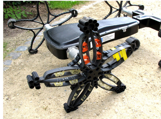
Abbildung 48: Modifiziertes Asguard-Rad zum Testen von Federelementen
