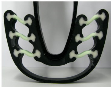
Abbildung 46: Versuchsaufbau und beispielhafte Ergebnisse für Belastungstests am neuen Fuß
