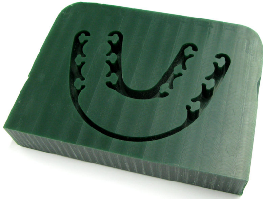
Abbildung 45: Gussform (l) und fertiges Bauteil (r) für die neue Fußstruktur.
