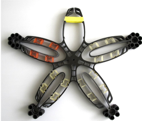
Abbildung 48: Modifiziertes Asguard-Rad zum Testen von Federelementen
