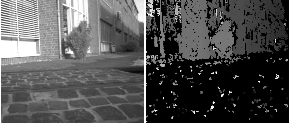
Abbildung 92: Ergebnis der Dense-Stereo-Tests. Links: Eines der Input-Bilder. Rechts: Berechnetes Tiefenbild. Schwarz: Keine Tiefeninformation extrahierbar, dunkle Farben entsprechen weiter entfernten Objekten, helle dem Nahbereich.
