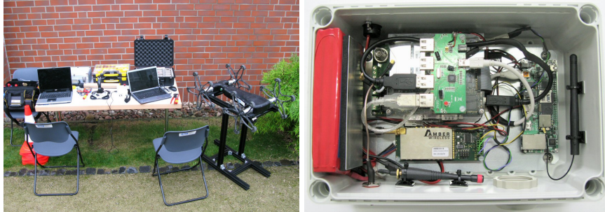
Abbildung 7: Die iMoby-Feldtest-Infrastruktur: iMoby-Iteration (Feldtest) und dGPS-Außenstation
