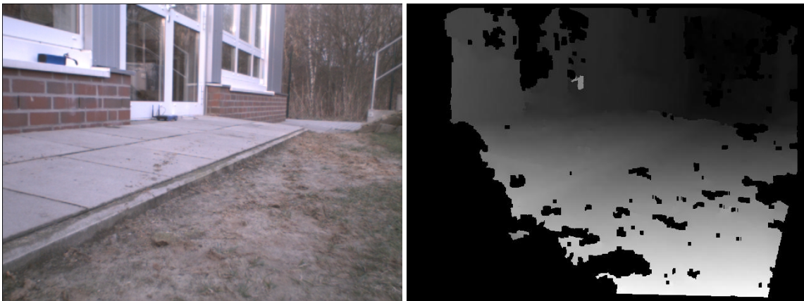
Abbildung 93: Kamerabild und aus dem entsprechenden Stereopaar errechnetes Tiefenbild.
