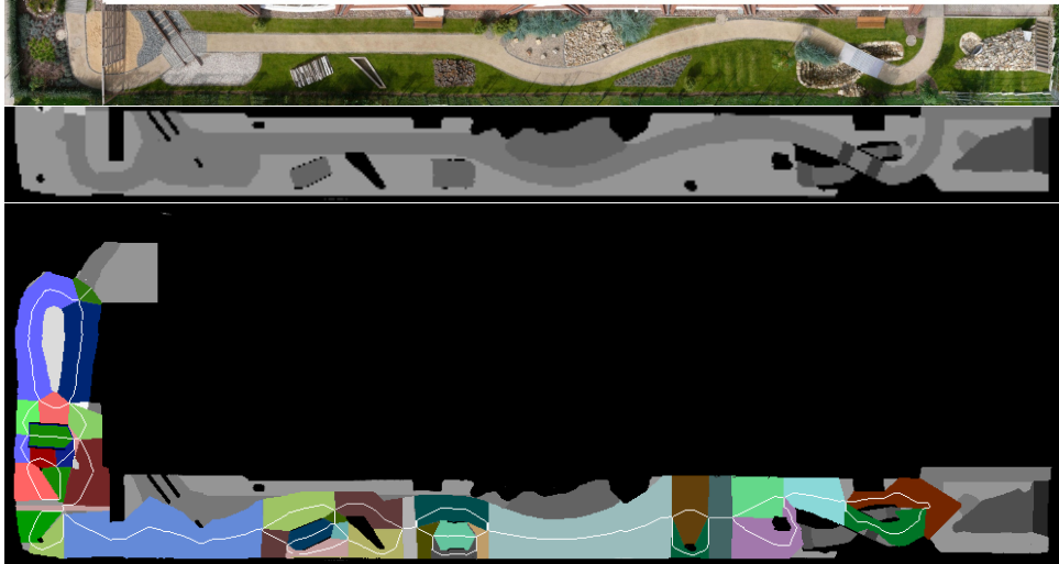
Abbildung 103: Ein Durchlauf des Planungsalgorithmus: Testgelände am DFKI aus der Vogelperspektive, manuell generierte Klassifizierung, Darstellung der Korridore
