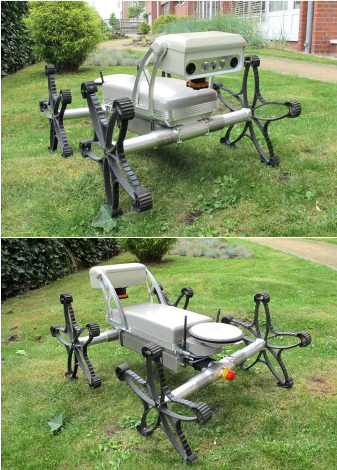
Abbildung 70: Das fertig integrierte Asguard-v4-System hat ein Gesamtgewicht von 16 kg.
