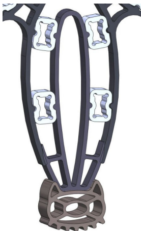
Abbildung 47: Konzepte zur Integration von Federelementen in das Asguard-Rad
