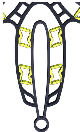
Abbildung 47: Konzepte zur Integration von Federelementen in das Asguard-Rad
