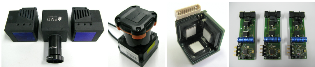
Abbildung 16: Sensoren des Asgard-Referenzsystems: PMD-Kamera, Hokuyo-Laserscanner, DFKI-IMU, H-Brücken-Module
