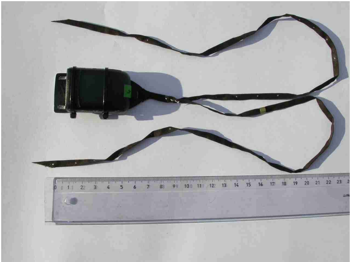
Abb. 1: GPS-Datenlogger mit Geschirr aus Teflonband zur externen Befestigung. Foto: V. Dierschke.
