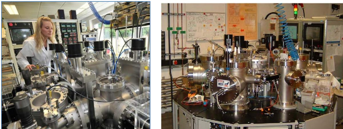
**Fig. 1.** Depositionsanlagen für die Herstellung von EPR-Proben: 6-Kammeranlage (links) und Clustertool I (rechts)
