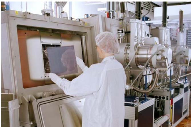
**Fig. 5.** Depositionsanlage für Herstellung von ZnO:Al Kontaktschichten mit Sputter-Prozessen
