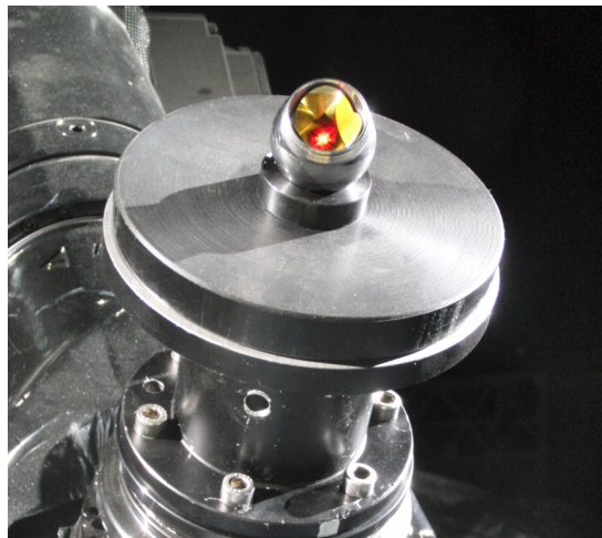
Abbildung 34: Laser-Tracker-Marker auf dem Kuka TCP
