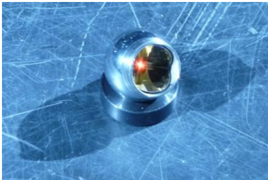
Abbildung 32: Laser-Tracker-Marker (Radius=25mm) auf dem Boden (Referenzpunkt 1)
