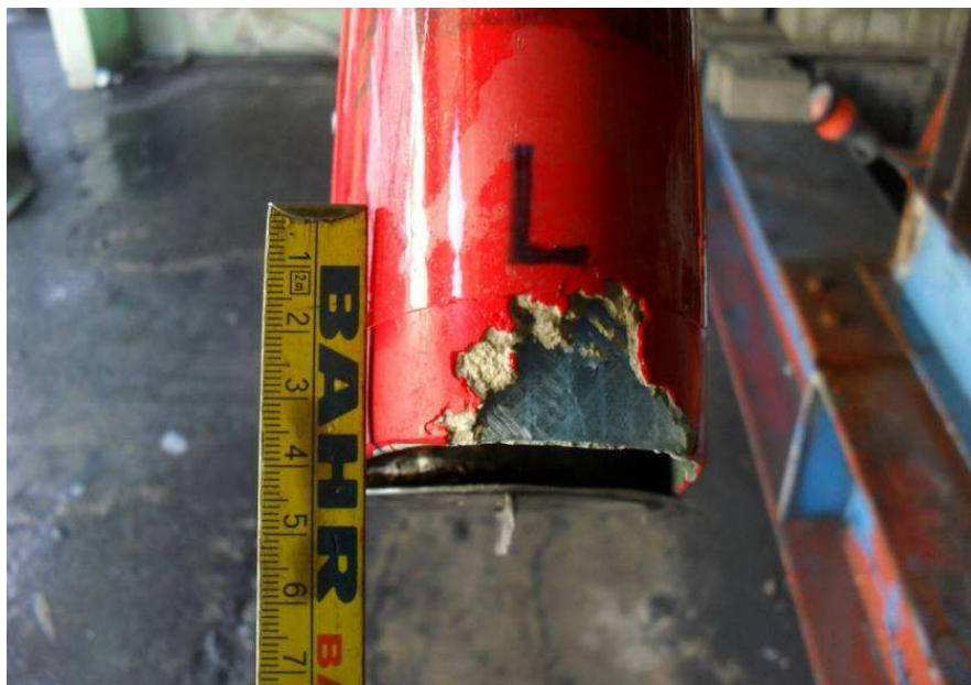
Abb. 5.2.10: Erosionserscheinungen am Versuchskörper nach einer Testphase von 1:15h
