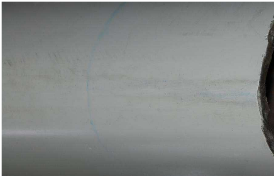
Abb. 5.2.7: Am Versuchskörper zeigen sich beginnende Erosionserscheinungen.
