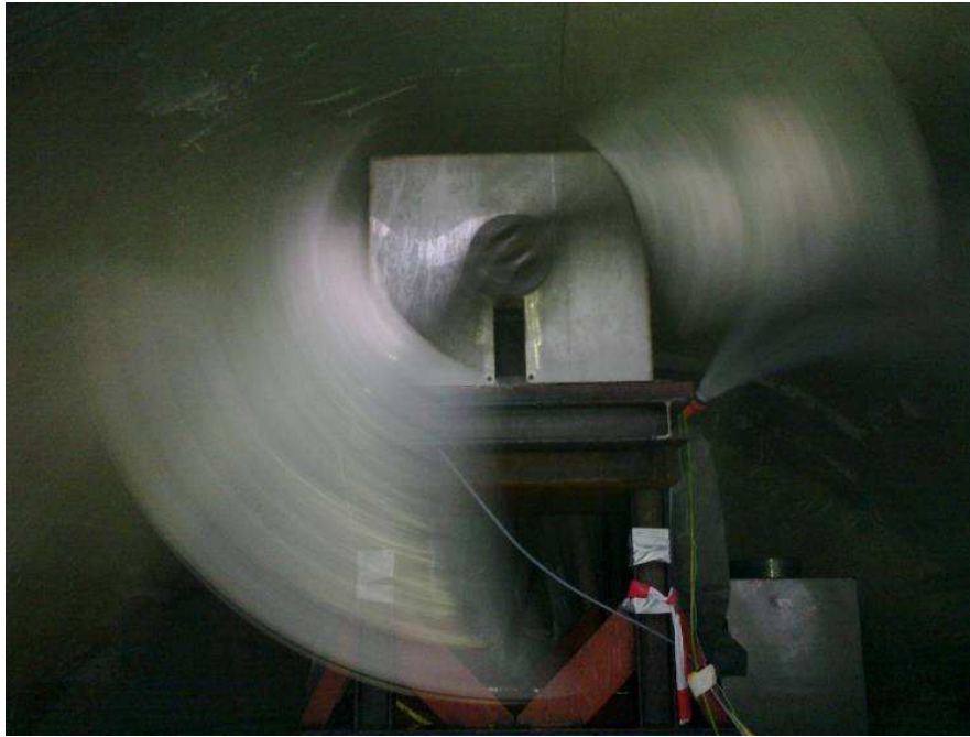
Abb. 5.2.6: Rotation von Versuchskörpern im Prototypen des Erosionsteststandes
