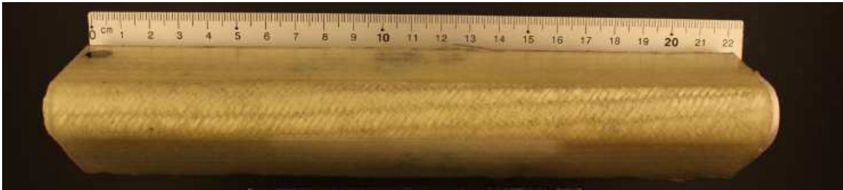
Abb. 5.2.19: Probekörper mit „AREVA 25a“ nach 9h Regenerosionstest
