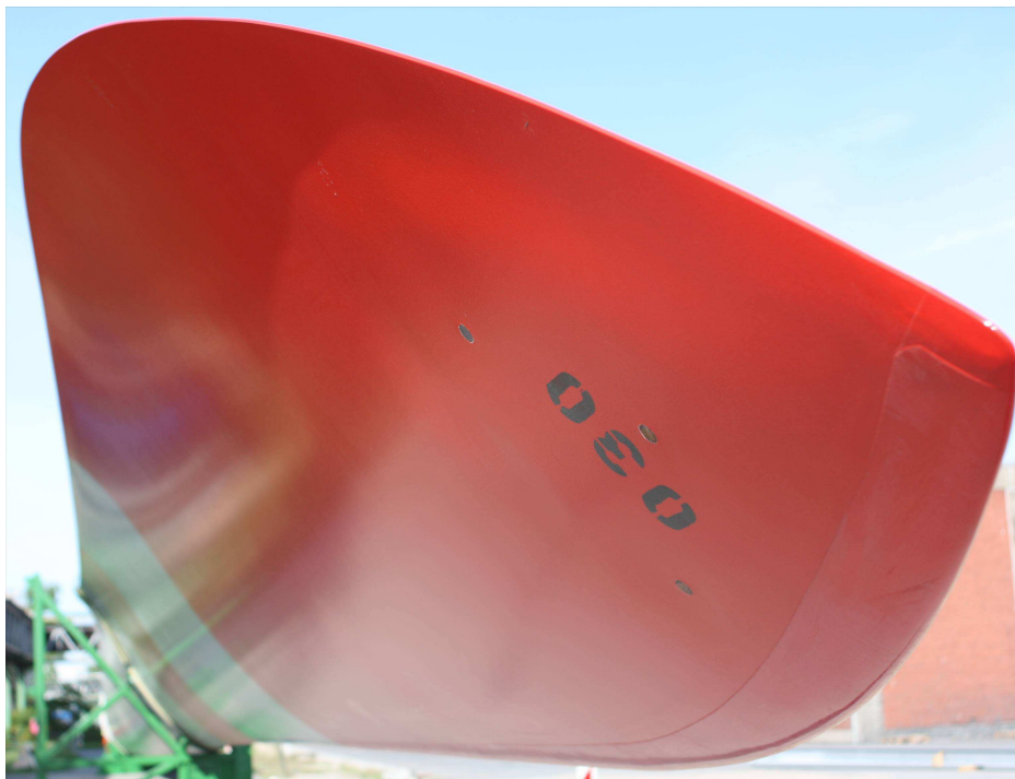
Abb. 5.2.21: Altes Erosionssystem; Erosionsschutzfolie
