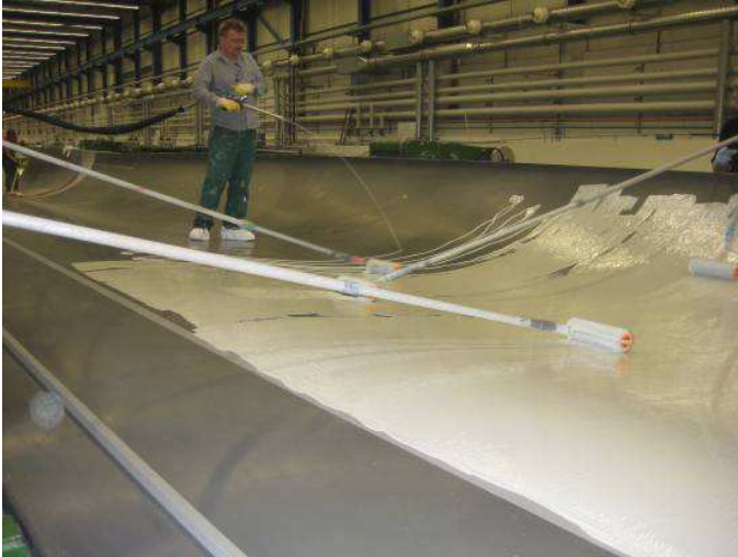
Abb. 5.1.1. Einbringen der Gelcoat-Oberflächenbeschichtung in die Rotorblattform
