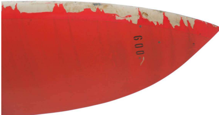
Abb. 5.2.1: Rotorblatt nach dreijährigem Betrieb ohne Erosionsschutzfolie
