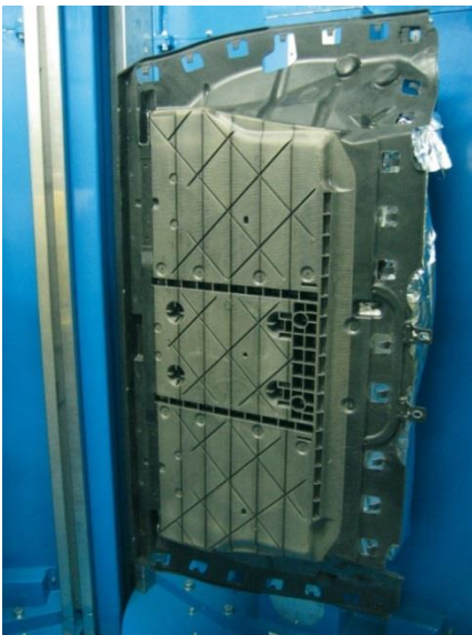
Abbildung 1: Partiiell Lasergereinigtes Bauteil aus faserverstärktem Polyurethan (Klebevorbereitung zur Kaschierung), Rechts: Zugscherfestigkeiten nach DIN 1465 bei laservorbereiteten CFK Proben (Referenz: manuelles Schleifen)
