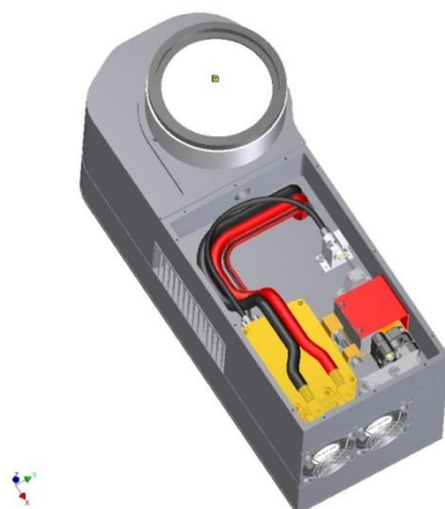
Abbildung 10: Kompaktlaser im solid Block mit integriertem Pump laser (Diodenlaser mit Pig-Tail Faser), unterseitig an Luftkanal montiert
