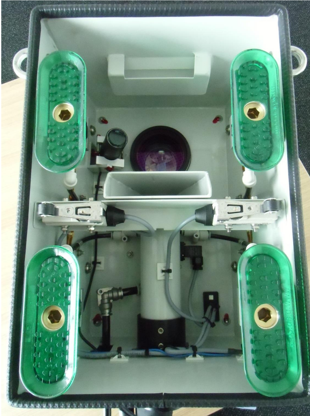
Abbildung 23: industrielle Weiterentwicklung des Bearbeitungskopfes nach Projektende (Innenansicht des Bearbeitungskopfes)
