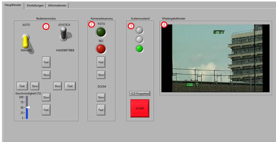
Abb. 68 Bedienoberfläche des Kamerasystems zur optischen Verfolgung der UAV
