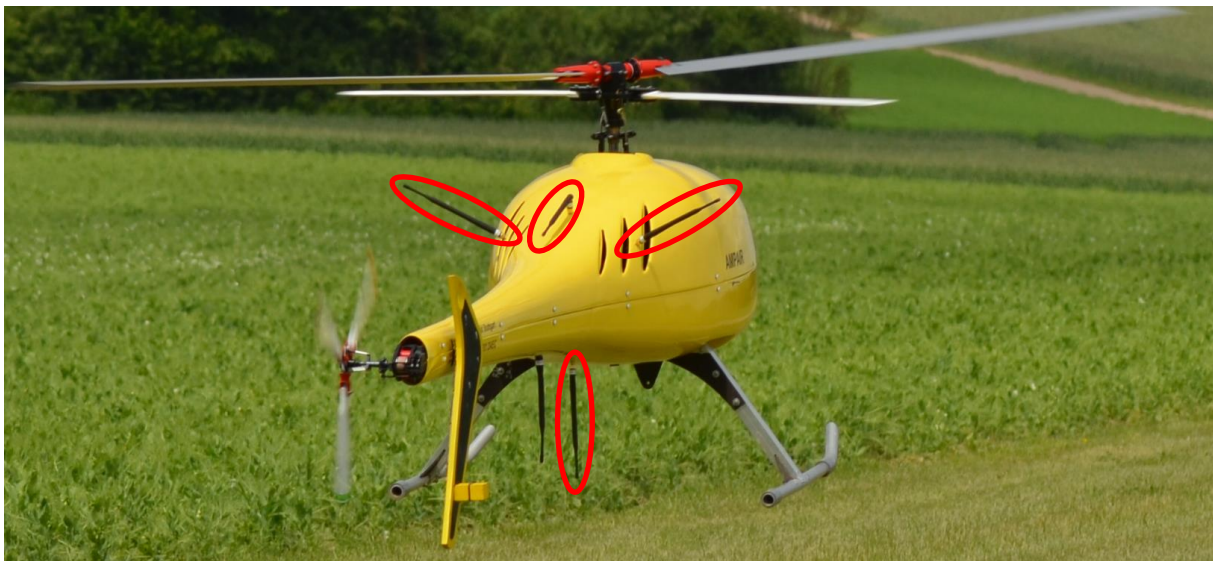
Abb. 32 anordnung der Empfangsantennen des AMPAIR
