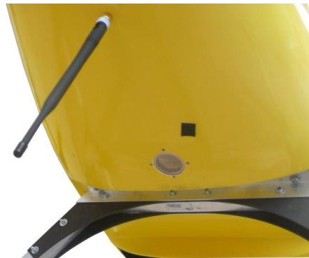
Abb. 29 AGL-Sensor an der Rumpfunterseite
