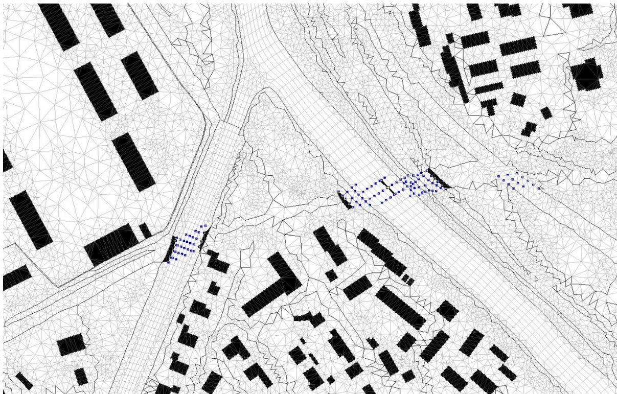
Abbildung 10 Detailausschnitt zur Visualisierung der Gitterstruktur im Fkm 19,5 bis 18,9 (graue Linien: Elemente; schwarze Linien: Materialgrenzen; schwarze Polygone: undurchströmbare Fließhindernisse wie Gebäude, Brückenpfeiler; blaue Punkte: Brückenunterkanten)
