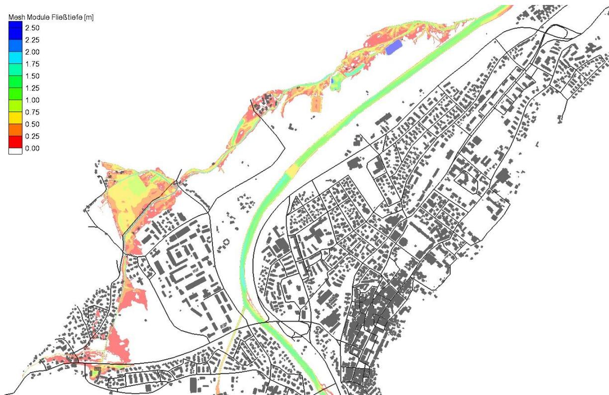
Abbildung 23 Lageplan maximal Fließtiefenverteilung bei  $HQ_{extrem}$  im Sebach
