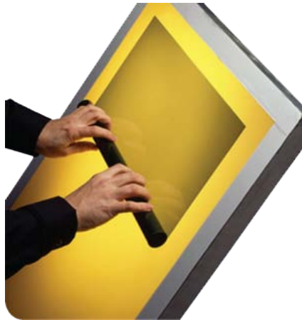
Abbildung 22: Kapillarfilme werden auf das vorher angefeuchtete Gewebe auf die Druckseite des Siebs aufgerollt. Bei hohen Filmstärken wird das zusätzliche Verkleben mit einer speziellen Emulsion von der Rakelseite notwendig. Quelle: (35)
