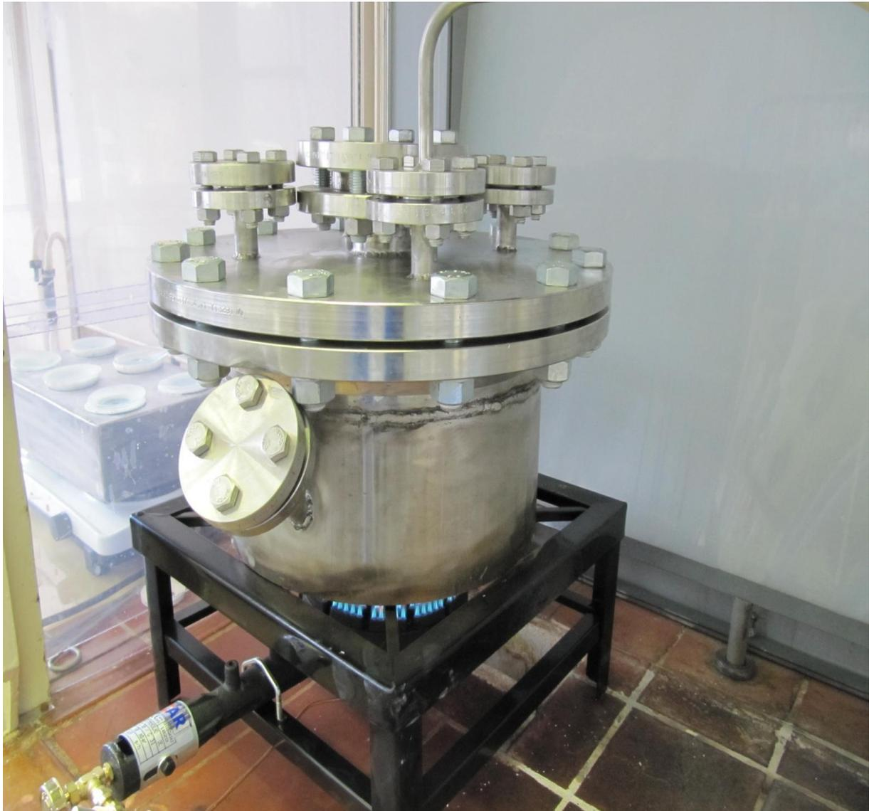
Abbildung 3 : Reaktionsgefäß mit Heizvorrichtung ( Propan – Ringbrenner )
