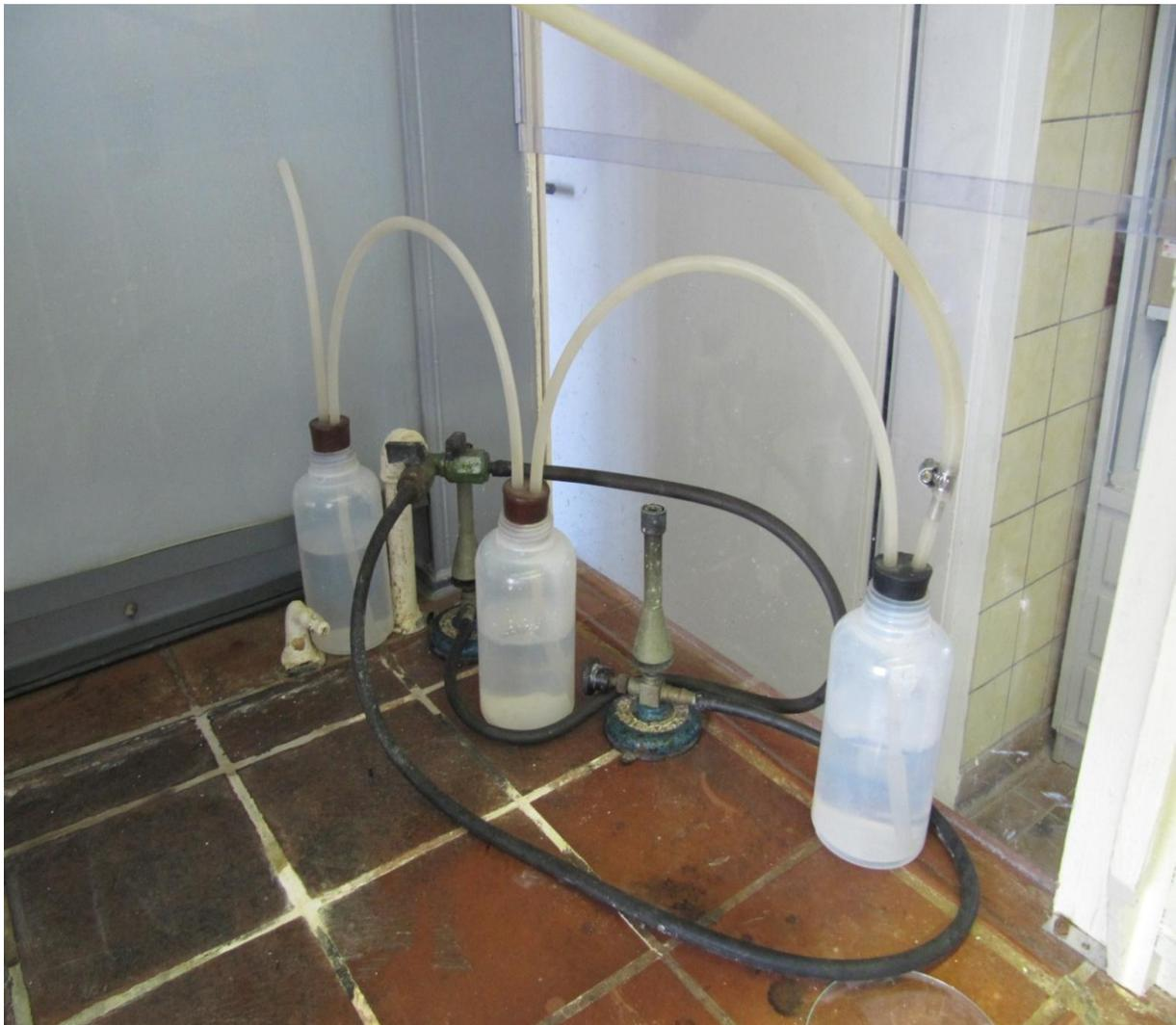
Abbildung 4 : Absorptionseinheit, Waschflaschenbatterie, bestehend aus drei 500 ml – PE – Flaschen
