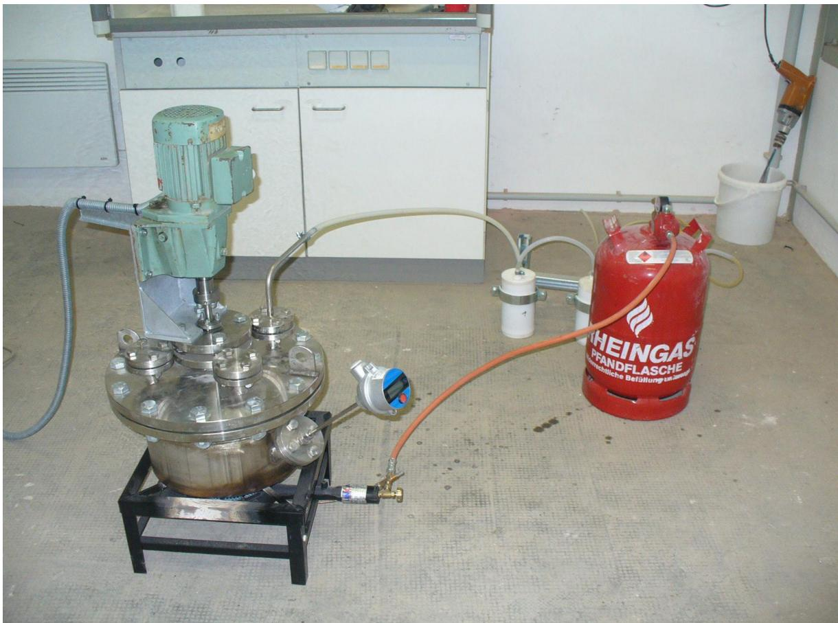
Abbildung 9: Reaktionsgefäß mit Rührwerk, Temperaturfühler und neuer Absorptionseinheit
