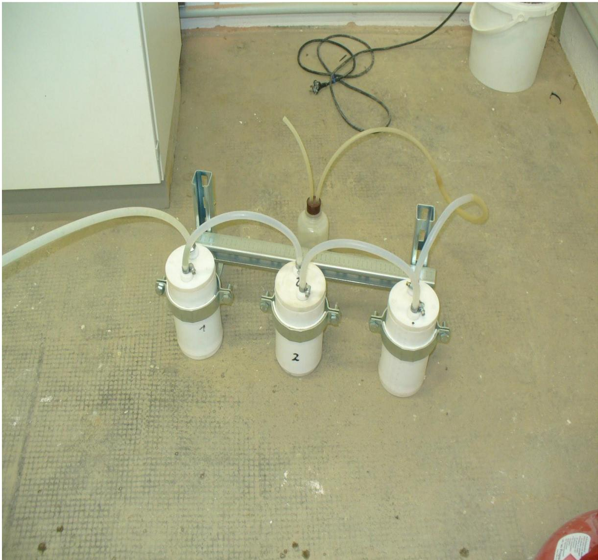
Abbildung 10: neue Absorptionseinheit aus PTFE ( Gefäße und Schläuche )
