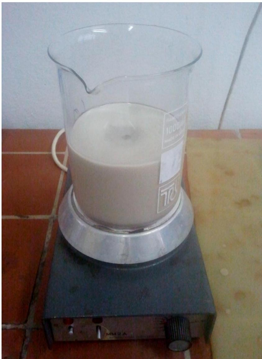
Abbildung 19: Reaktionsgefäß mit Magnetrührwerk
