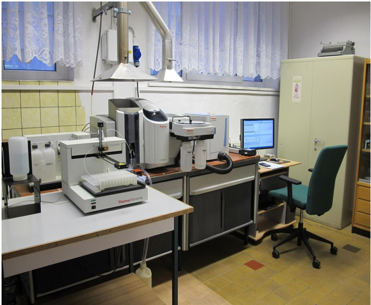
Abbildung 1 - AAS ice 3500 (Thermo Scientific) für Flammen -, Graphitrohr - und Hydridtechnik
