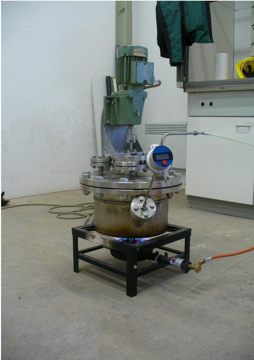
Abbildung 11: nachgerüsteter Temperaturfühler
