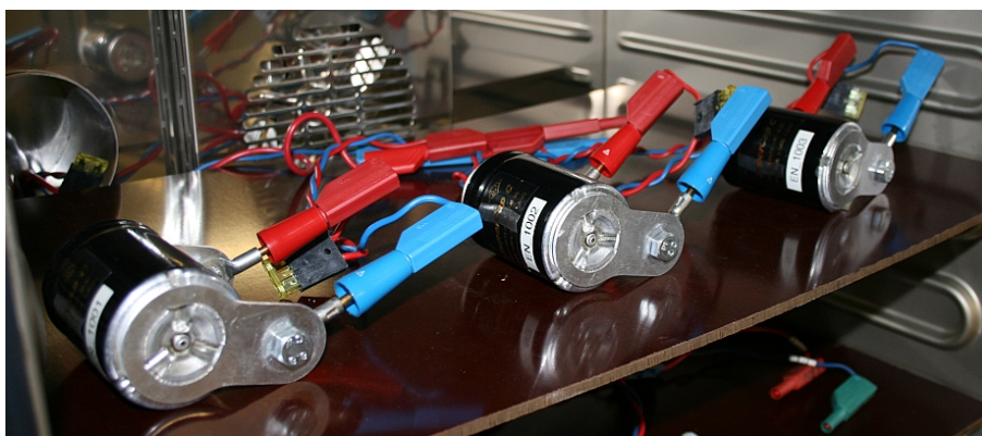
Abbildung 2.4: Testaufbau kalendrische Alterungstests. Hier abgebildet sind die Generation 0 Zellen.
