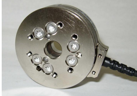
Abbildung 60: ATI Mini45 sechs Achsen Kraft- und Drehmoment-Sensor
