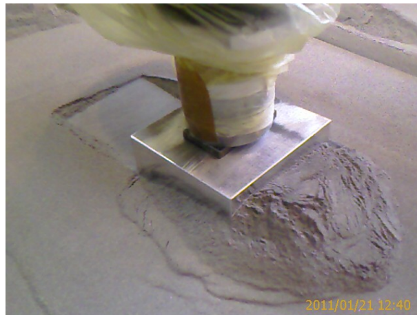
Abbildung 123: Referenzexperiment RE41 unter Verwendung des Quaders (B10) um die Boden-Interaktionskräfte zu messen.
