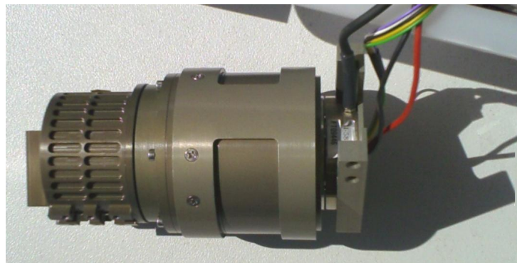
Abbildung 59: SpaceClimber-Gelenk, ausgerüstet mit einem ATI Mini45 sechs Achsen Kraft- und Drehmoment-Sensor
