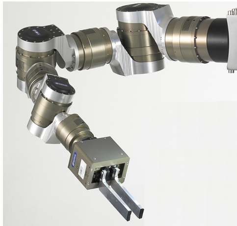
Abbildung 62: Realer Schunk Roboterarm mit sieben Freiheitsgraden.
