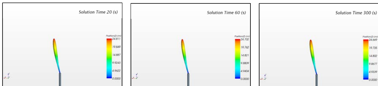
Abb. II.6 4 % CH 4 – Konzentration für die Zeitschritte 20 s, 60 s sowie 300 s
