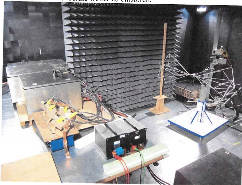
Abbildung 17: Testaufbau EMV- Störungen
