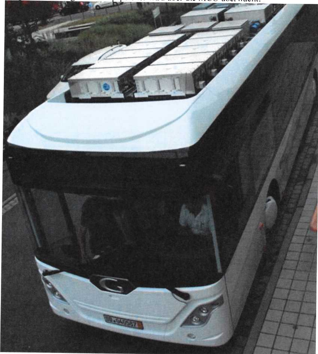
Abbildung 4: auf der Autotram montierter Supercapspeicher mit DCDC Konverter
