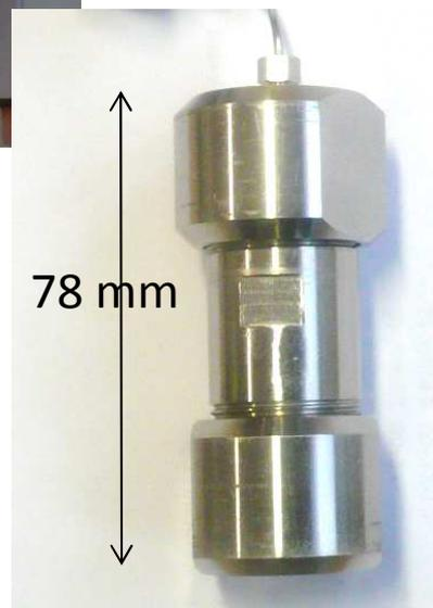
Abbildung 31: Foto der Anlage zur Verfolgung von Löseprozessen mittels Ramanspektroskopie und optischer Indikation
