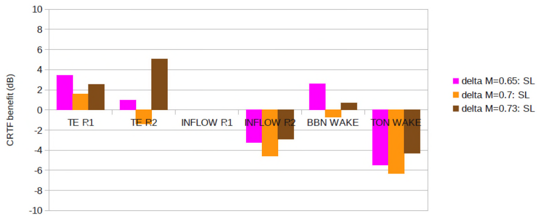
Abbildung 44: Vergleich einzelner Lärmquellen, CRTF vs. TF bei Sideline
