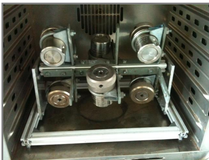
Abbildung 2: 12-fach Reaktor, hier mit sechs 20ml-Hochdruckautoklaven, eingespannt in ein Haltesystem und gelagert auf einer rotierenden Zentralachse.
