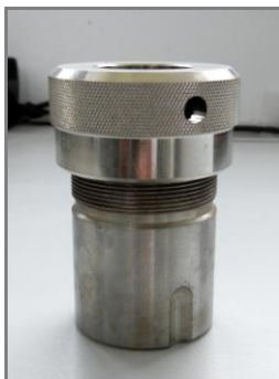
Abbildung 1: 20ml Hochdruckautoklav mit Schraubverschluss und Berstscheibe
