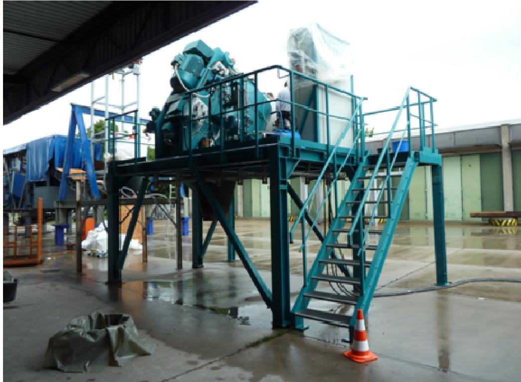
Bild D9: Intensivmischer R15 (Nutzschicht)
