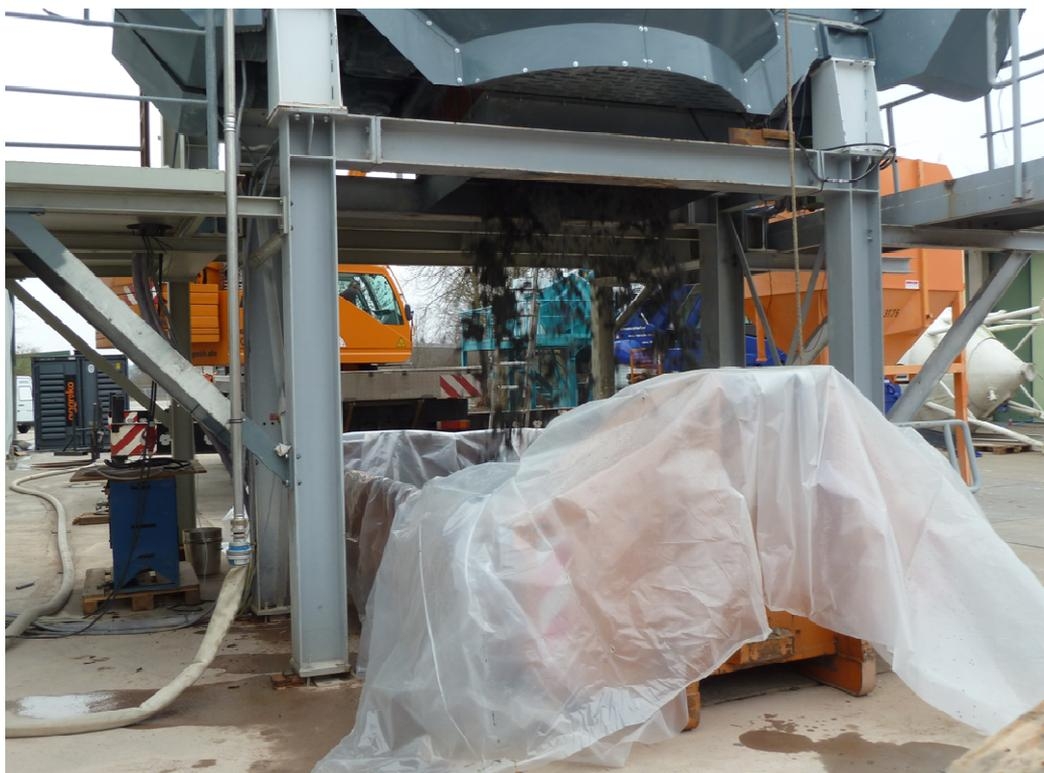
Bild D12: Auslass Probemischung Deckschicht
