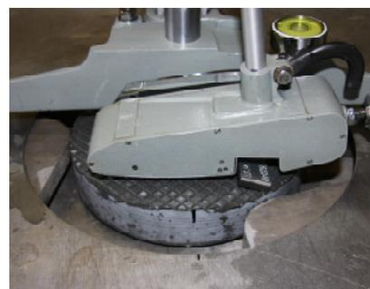
Abbildung II.1.5 : SRT-Gerät der BAST
