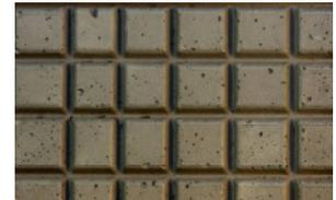
Abbildung II.1.4 : Texturierung mittels Aufbetonieren
