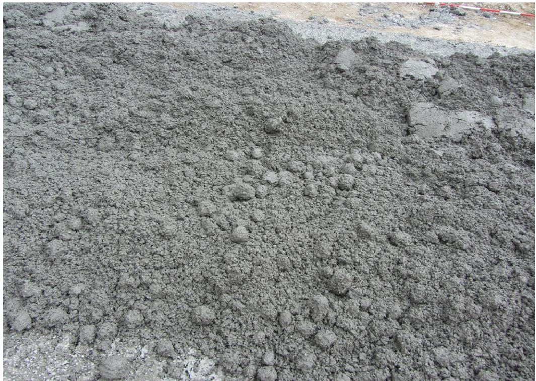
Bild D2: Deckschichtmischung aus dem Holcim Doppelwellenzwangsmischer
