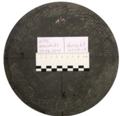
Abbildung II.1.2: Prototyp des mittels Stempeln geprägten Probekörpers
