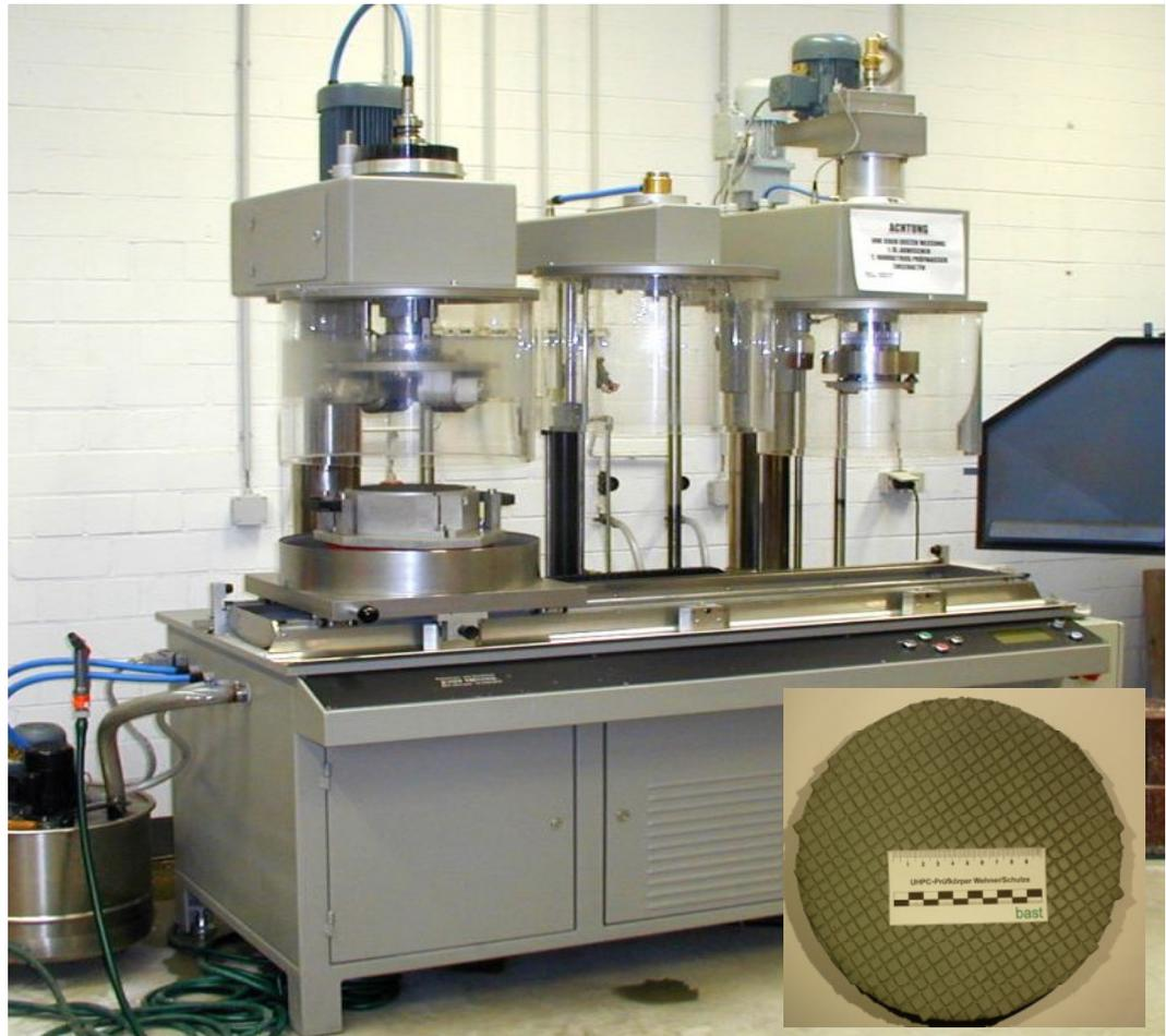
Abbildung I.4.2: Wehner/Schulze-Gerät im Labor der BAST und geprägter Prüfkörper
