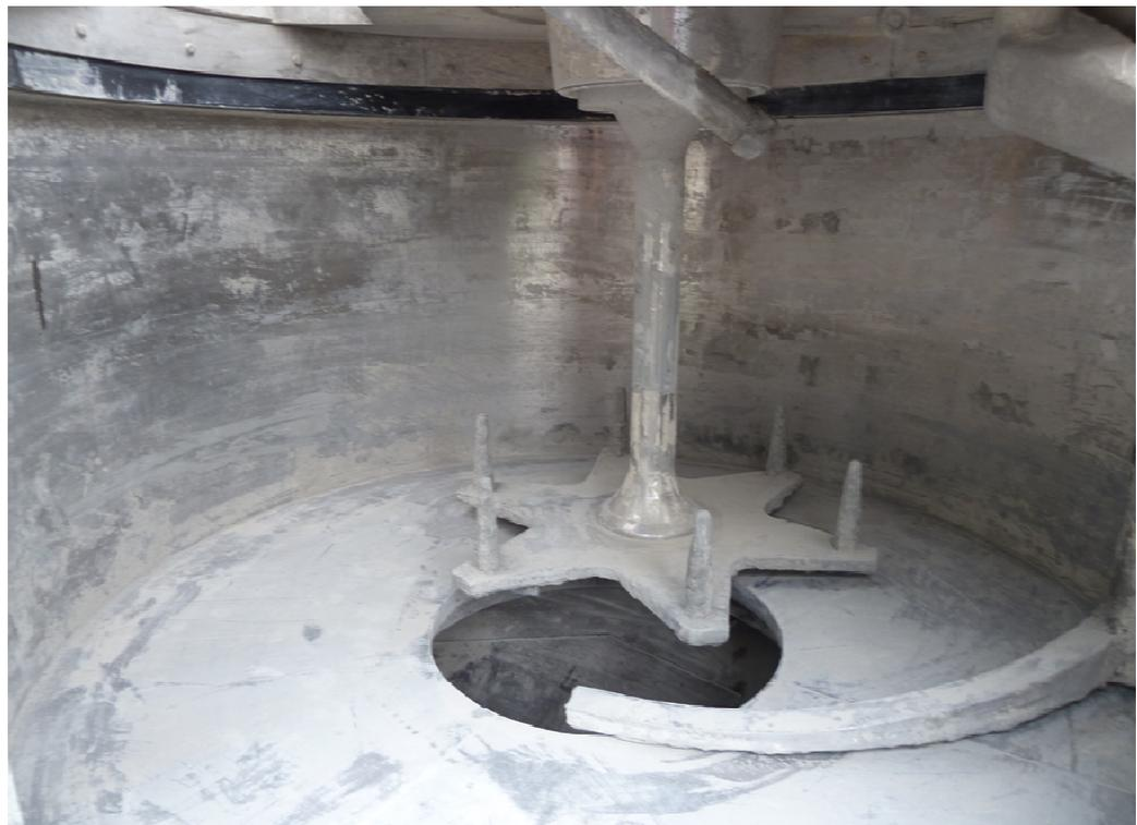
Bild D10: Blick in den Mischtrog des R15 (Sternwirbler)
