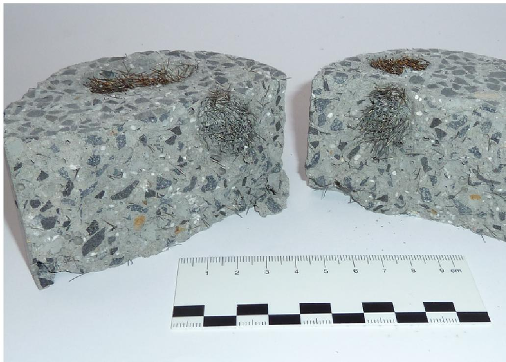
Bild D4: Spaltzugprobekörper nach Prüfung (aus dem Doppelwellenzwangsmischer von Holcim; deutlich erkennbare Fasernester)
