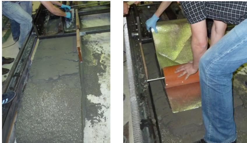
Abbildung II.1.14: Laboreinbau der Deck- und Nuttschicht mit anschließender Prägung
