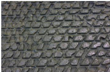
Abbildung II.1.3: Luft einschüsse auf der Mörteloberfläche
