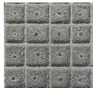
Abbildung II.1.7: Prägung mit Entlüftungsbohrungen (Nullzustand ohne Beanspruchung)
