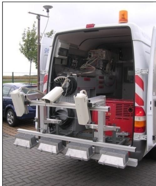
Abbildung II.1.30: Schnellfahrendes Rissaufnahme-System „RoadControl“
