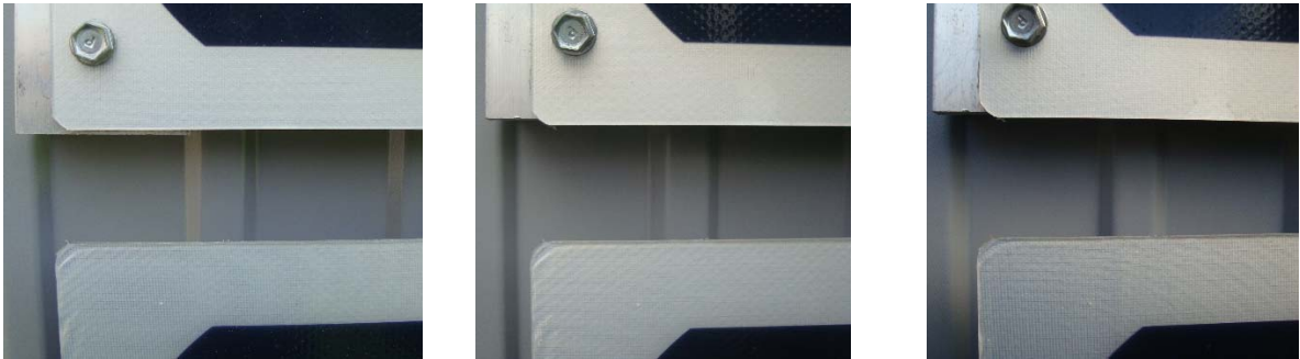
Abbildung 7-64: Kanten der PV-Fassadenprototypen im Ost zu unterschiedlichen Zeitpunkten aufgenommen (links: 16.05.2013, mittig: 12.08.2013, rechts: 21.11.2013)
