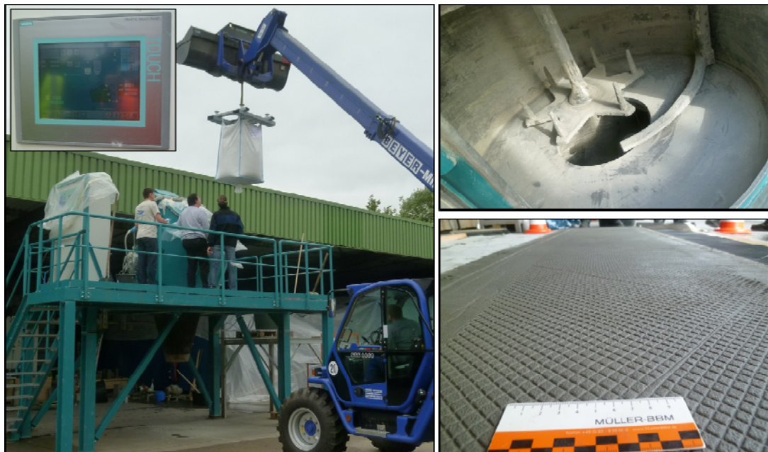
Abbildung 15: Mischversuche zur Herstellung der Nutzschrift am 17.- 18.07.12 bei der Fa. Eirich. Eirich-Intensivmischer, Modul R15 mit Steuereinheit (links), Blick in den Mischbehälter (oben rechts) und eingebaute texturierte Nutzschriftmischung
