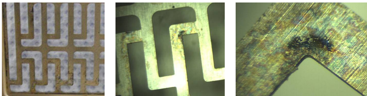
Abbildung 7: Monopolarer Stromableiter nach Korrosionstest, Darstellung in unterschiedlicher Detaillierung
