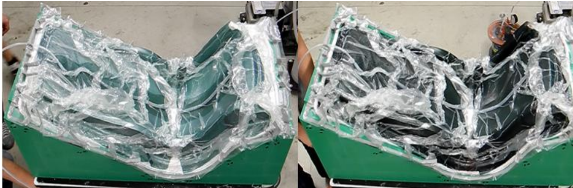
Abbildung 9: Infusionsprozess, links: Beginn der Infusion, rechts: Infusion abgeschlossen
