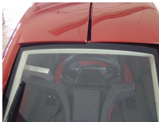
Abbildung 28: Maßhaltigkeit der Türen im Vergleich, deutliche Maßabweichungen der linken PUR-Tür (rechts im Bild)
