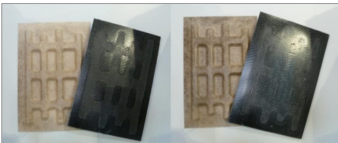
Abbildung 24: PP/Flachs-Hybridfaservlies (Nr. 2) mit PP/GF-Organoblech (Nr. 5) verpresst; links: Organoblech in IR-Heizstation erwärmt; rechts: Organoblech in Vorheizpresse erwärmt
