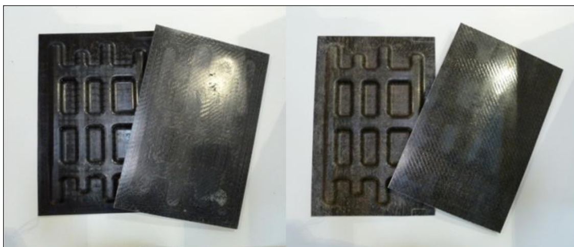
Abbildung 25: links: PP/GF-Wirrfaserplatte (Nr. 3) mit PP/GF-Organoblech (Nr. 5) verpresst; rechts: PA6/GF-Wirrfaserplatte (Nr. 6) mit PA6/GF-Organoblech (Nr. 7) mit warmhärtendem Klebstoff gefügt
