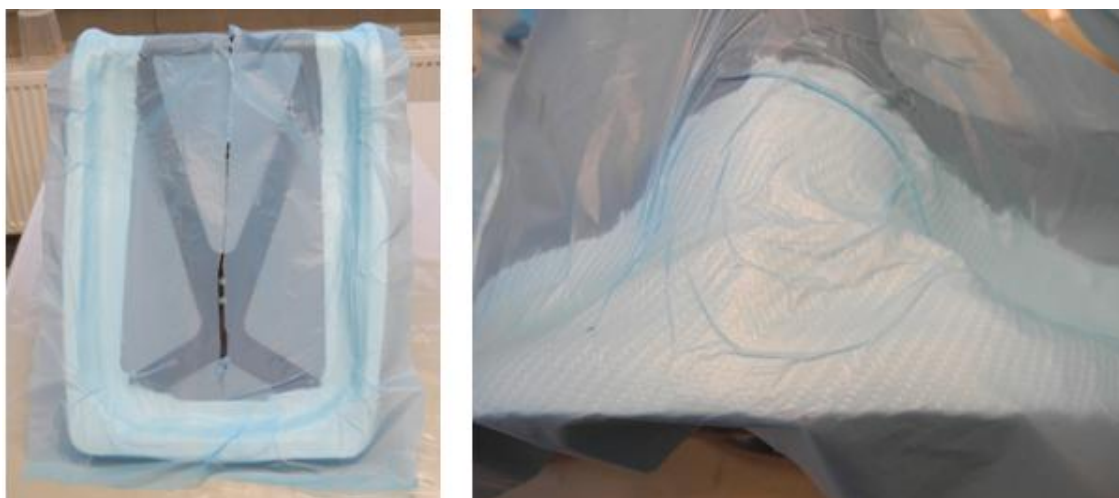
Abbildung 13: links: Herstellung geschlossenes Sitzprofil, rechts: Detail, Herausbildung des Profils
