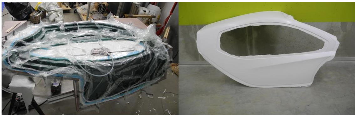
Abbildung 26: links: Türinnenteil bei der Vakuuminfusion, rechts: entformtes Türaußenteil
