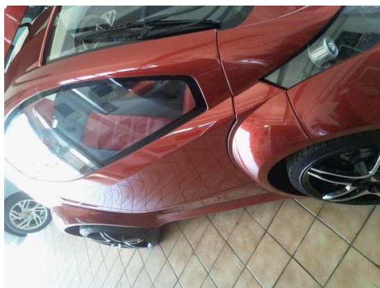
Abbildung 27: Konturabweichung zwischen GFK-Tür und Seitenteil durch Fertigungstoleranzen, Verwindung und fehlende Montagereferenzen
