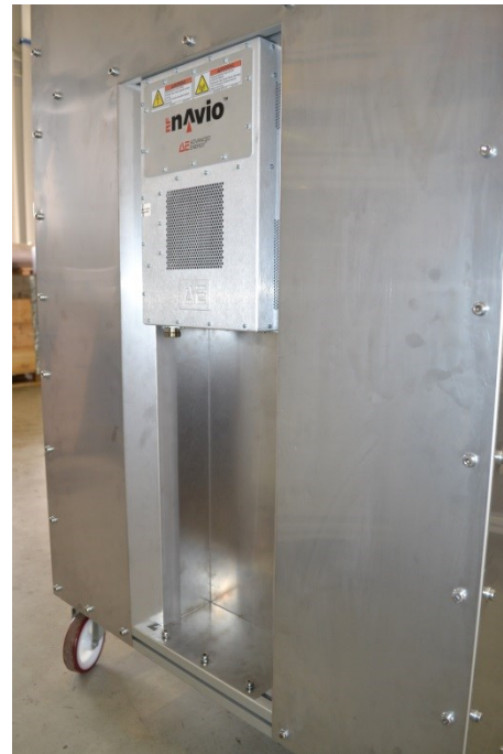
Abbildung 43 : Edelstahlplatten zur Schirmung
