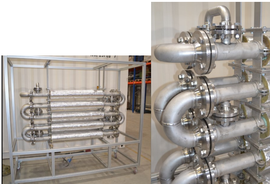
Abbildung 37 : Gas-Gas-Wärmeübertrager für den O 2 -Demonstrator
