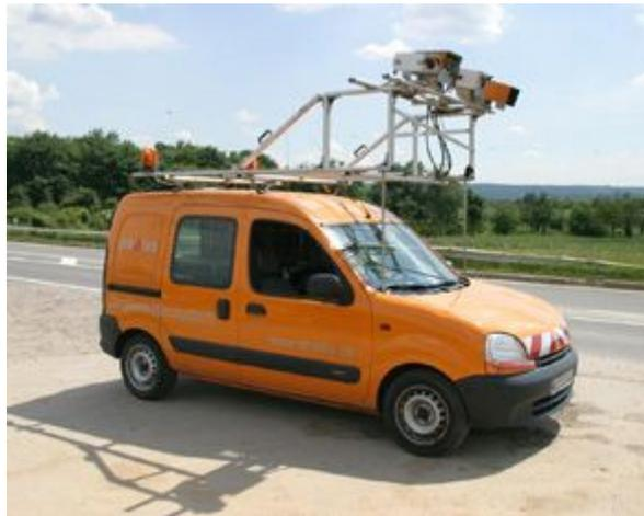
*Abbildung 1: Kamerabestücktes Erfassungsfahrzeug der Stradis GmbH*
