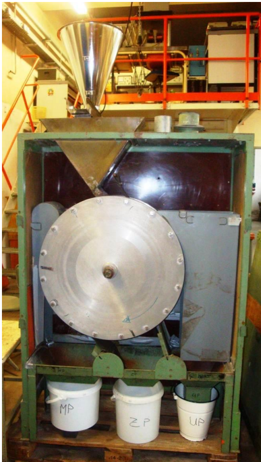
Bild 23: Permanent-Magnet-Trommel-Scheider PMTA 630/110 mit aufgesetzter Schwingrinne und Behälter für das magnetische Produkt (MP), das Zwischenprodukt (ZP) und das unmagnetische Produkt (UP)
