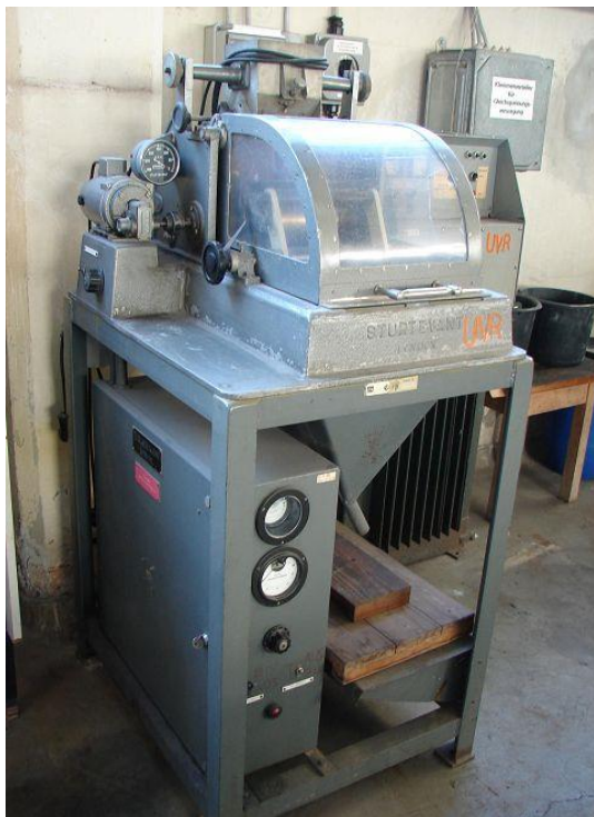
Bild 27: Labor-Einwalzen-Korona-Scheider STURTEVANT (links) Austrag der Trennprodukte Leiterprodukt, Zwischenprodukt und Nichtleiterprodukt (rechts)
