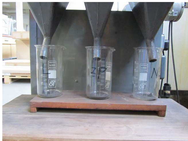
Bild 27: Labor-Einwalzen-Korona-Scheider STURTEVANT (links) Austrag der Trennprodukte Leiterprodukt, Zwischenprodukt und Nichtleiterprodukt (rechts)
