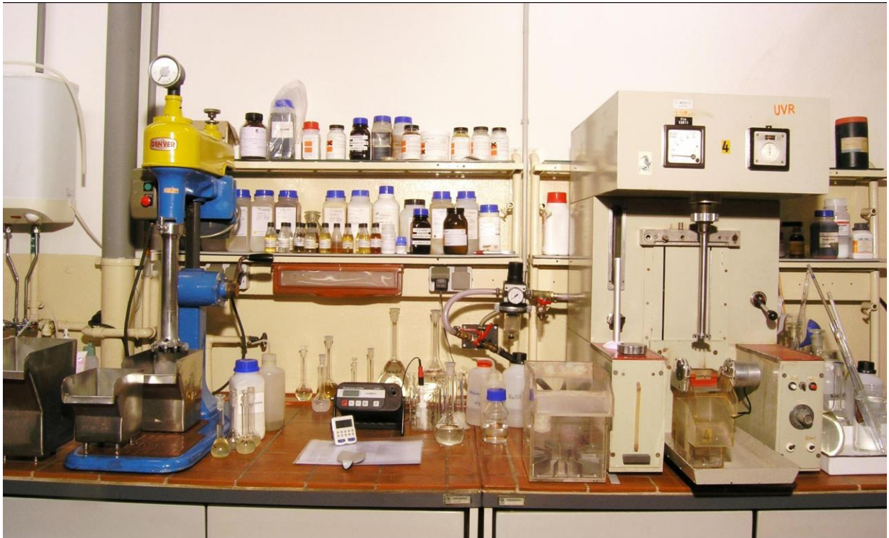
Bild 6: Laborflotationsapparaturen links Bauart DENVER: 1/2/5 | Rührwerkszelle mit Rotor-Stator-System, eigenbelüftet, rechts Bauart FIA 0,5/1/2/5 | Rührwerkszelle mit Rotor-Stator-System, fremdbelüftet
