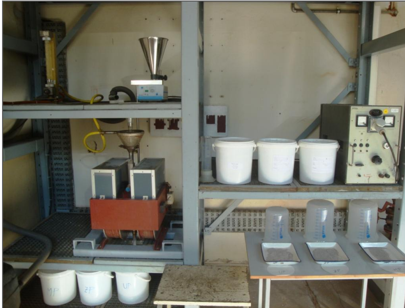
Bild 2: Labor-Starkfeldmagnetscheidungsanlage, rechts: Elektromagnet mit Matrix-Kammer, max. magnetische Flußdichte 1,8 Tesla
