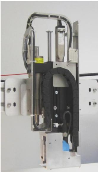
**Abbildung 13:** Aufbau einer aktiven Höhennachführung bestehend aus Linearmotor, Führung, Abstandssensor (blau), Flansch für Befestigung des Messkopfes und magnetische Feder, die im Falle eines Stromausfalls das Ganze an den oberen Anschlag drückt.
