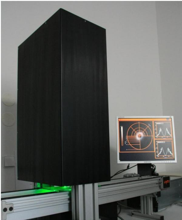
**Abbildung 9:** Foto des Funktionsmusters kombiniert mit dem Fördererelement. Im Hintergrund ist die Benutzeroberfläche auf dem Monitor des Mess-Computers zu erkennen. Eine Probe TCO beschichtetes Glas befindet sich unter dem Messkopf. An Ihr gestreutes grünes Laserlicht ist sichtbar.
