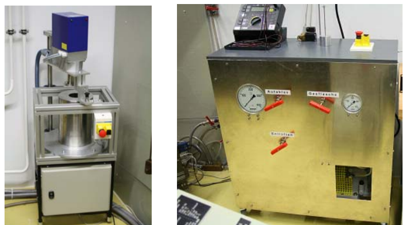
Abb. 2: Druckbehälter des Gasladers und Kompressor
