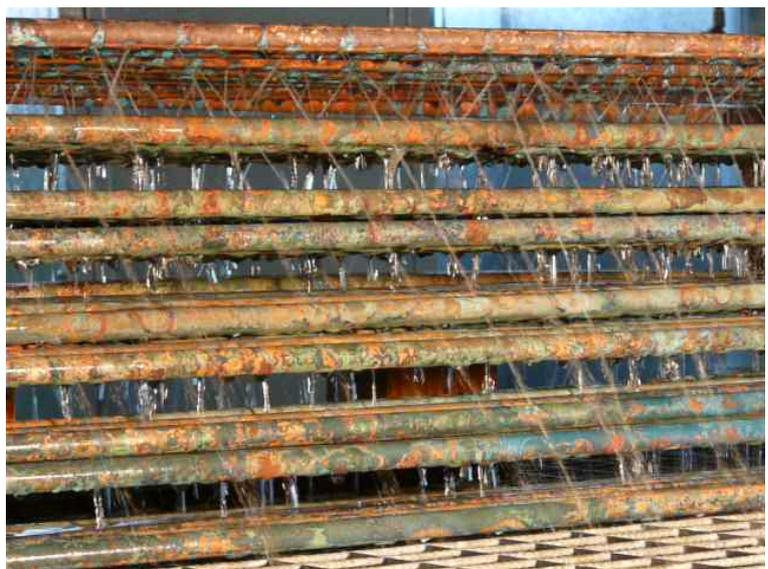
Abb. 12: Untersuchung zur Berieselungsgüte des Absorbers (alte Ausführung)
