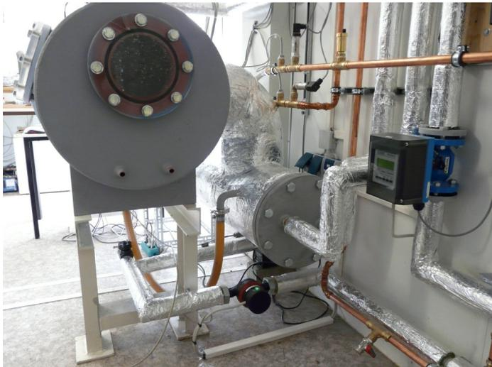
Abb. 14: Seitenansicht des Absorberbehälters mit externem Austreiber zur Kältemitteldampferzeugung
