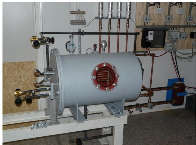
Abb. 13: Experimenteller Aufbau des Versuchsstandes mit dem Absorberbehälter
