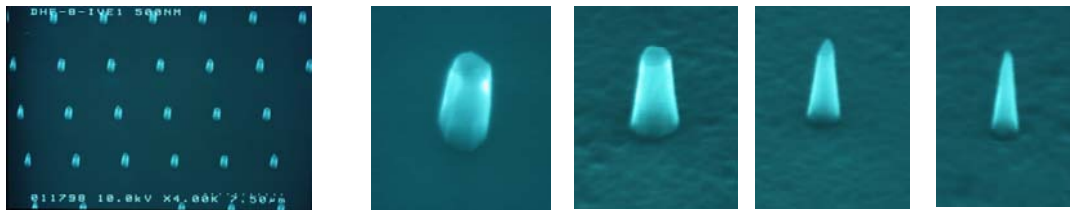
Abb. 3. Feld von Diamantnanosäulen und einzelnen Nanosäulen mit Durchmessern von 500, 200, 100 und 50 nm
