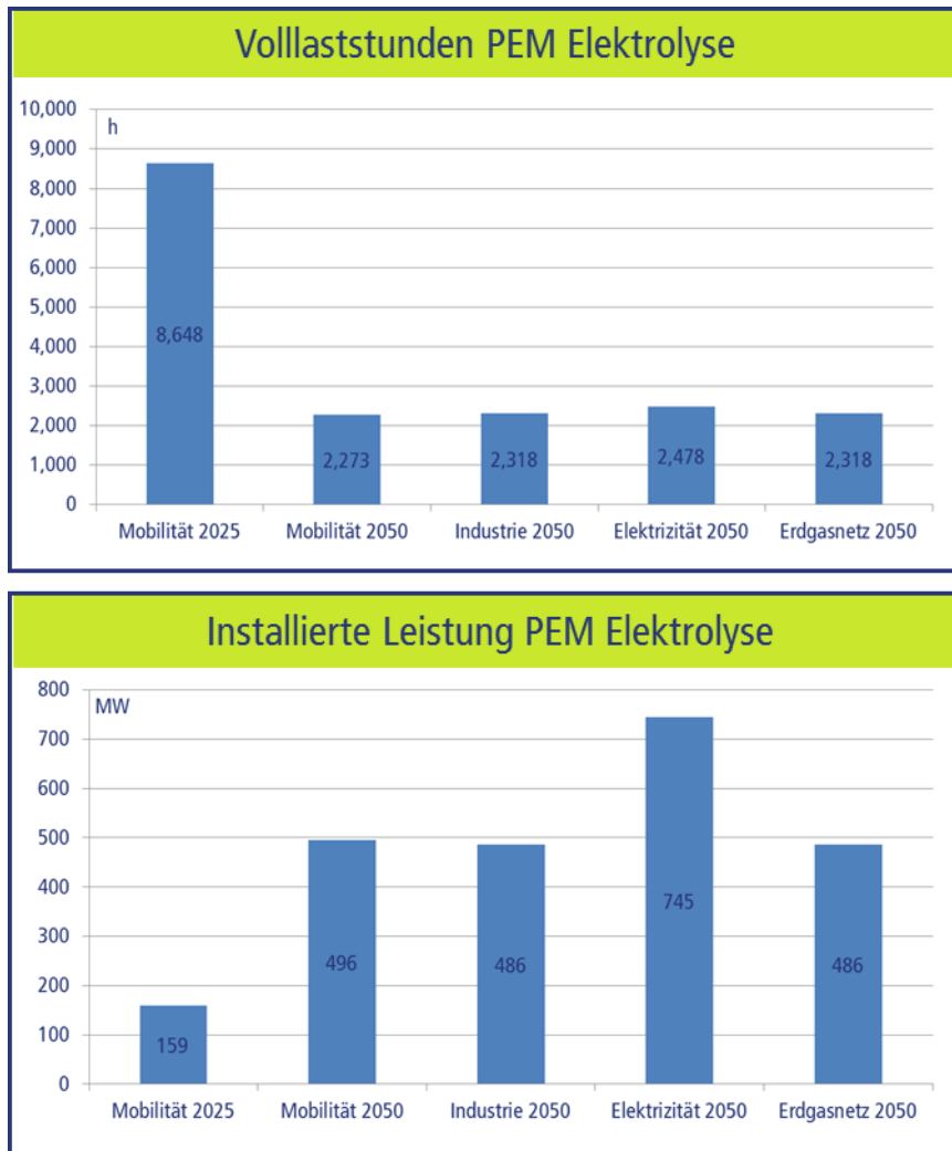
Abbildung 4-19: Auslastung und installierte Leistung der PEM-Elektrolyse
