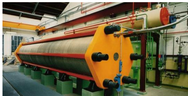
Abbildung 1-14: Druckelektrolyseur nach dem System LURGI [ELT 2, 2014]
