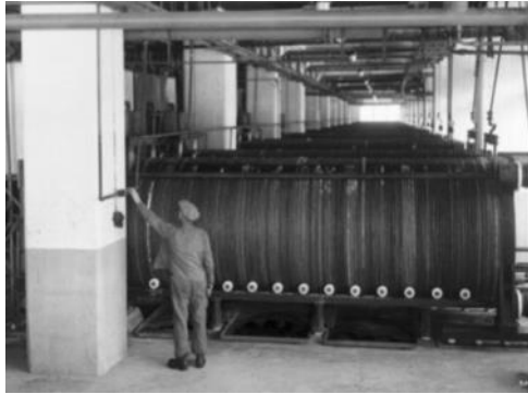
Abbildung 1-11: 30.000 Nm 3 /h-Anlage bei NEL in Rjukan [NEL 1, 2014]
