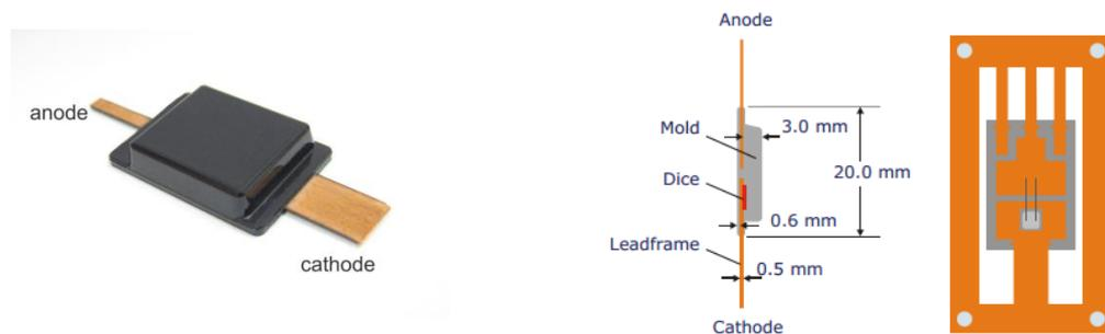
Abbildung 7: a) Gehäuse für die 6,5 kV SiC pin-Diode (links), b) Schematischer Aufbau des Gehäuses (rechts).
