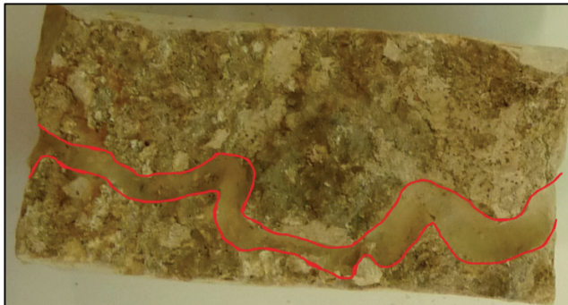
Abbildung 5 a: Analogmaterial („Treuchtlinger Marmor“) mit vorgeprägter Kluft nach der HCl-Polymerdurchströmung. Im Bild rechts sind typische Wormholes (Wurmlöcher) infolge Reaktion der Salzsäure zu erkennen.
