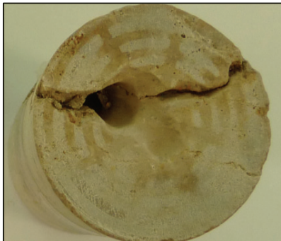
Abbildung 5 a: Analogmaterial („Treuchtlinger Marmor“) mit vorgeprägter Kluft nach der HCl-Polymerdurchströmung. Im Bild rechts sind typische Wormholes (Wurmlöcher) infolge Reaktion der Salzsäure zu erkennen.
