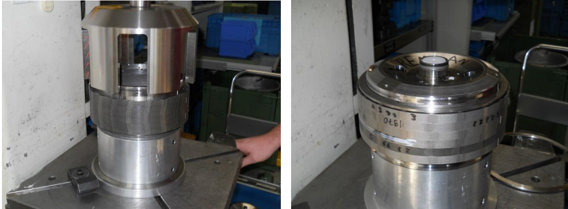
Abbildung 19: links: Abpressen der Rotorsegmente, rechts: mit abgepressten Segmenten neu aufgebauter Rotor
