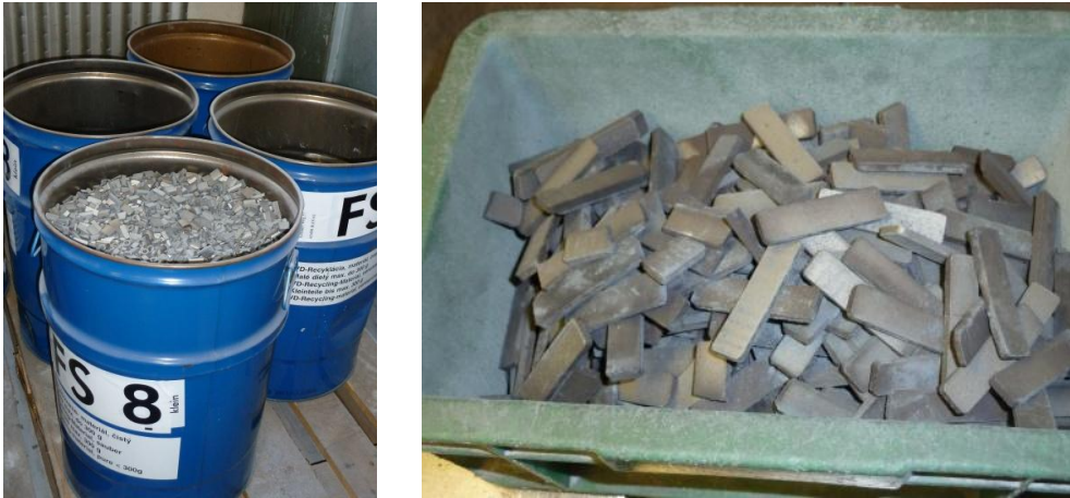
Abbildung 48: Sammlung von Ausfall-Magneten vor und nach der Reinigung
