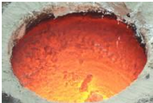
Abbildung 49: Einschmelzen von Ausfall-Magneten im Vakuuminduktionsofen
