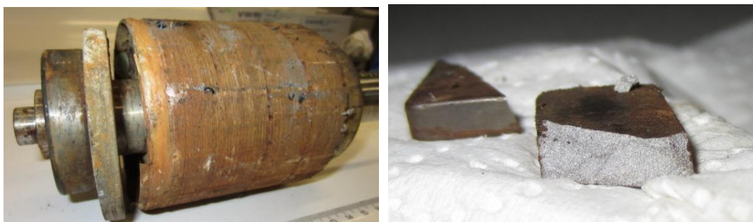
Abbildung 12: links: stark verschmutzter Rückläuferrotor, rechts: Bruchfläche eines nur äußerlich verschmutzten Magneten dieses Rotors
