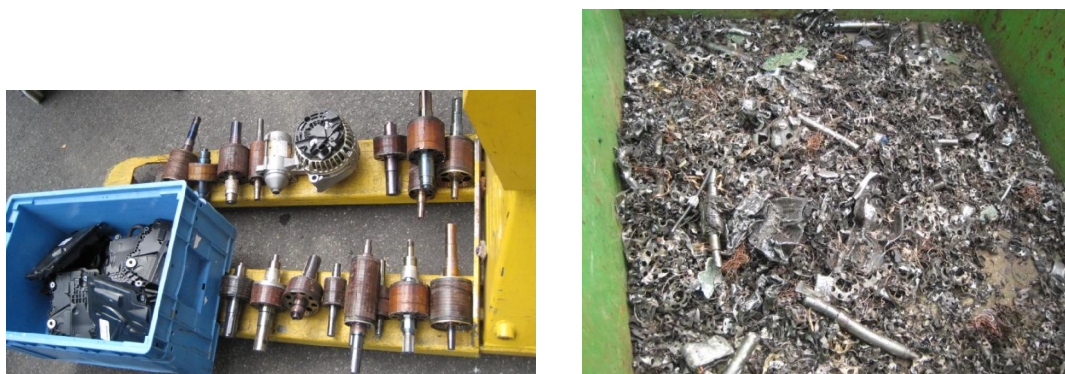
Abbildung 54: links: Beispiel für Shredder-Input-Zusammensetzung; rechts: Zerkleinertes Material
