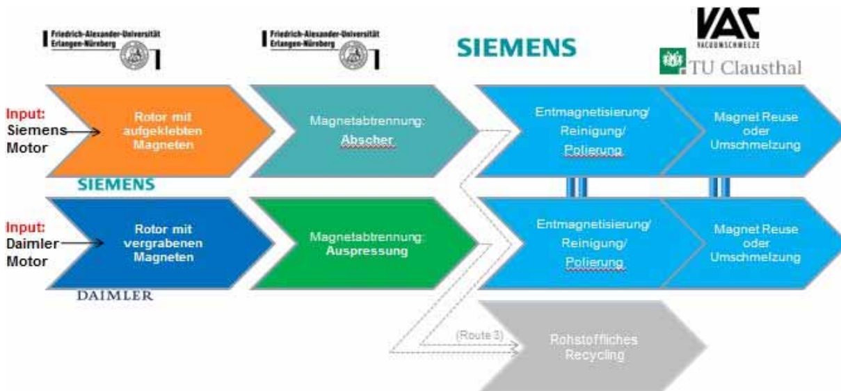
Abbildung 3-1: Demontage und Reinigung von aufgeklebten und vergrabenen Magneten
