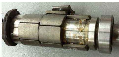
Abbildung 25: Magnetisierter Rotor nach Behandlung in Natronlauge und Entfernung der Bandagierung
