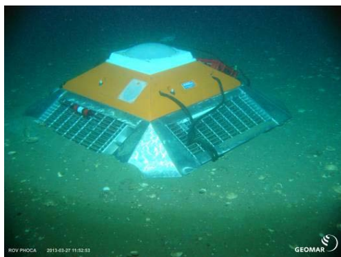
Abb. 14: (a) Zentrale Landereinheit (geeignet auch für Fischereigebiete); (b) HISEM System (Sensoreinheit und Energieversorgung).
