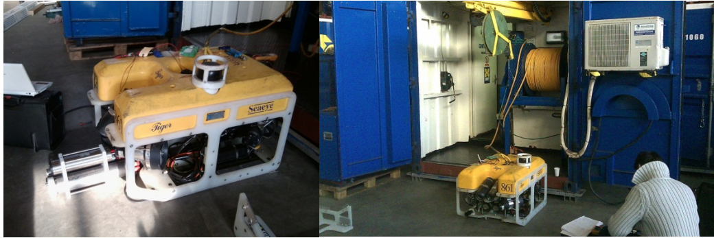
Abb. 3: Erste Software und Hardware Tests zur Sensor-Adaption am Inspektions-ROV Tiger – Seaeye.
