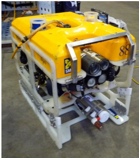
Abb. 4: Im Tiger ROV eingebautes HISEM-System.
