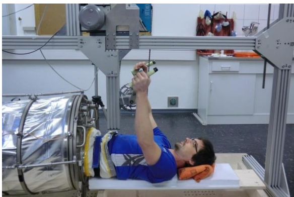
Abb. 54 Positionierung der Probanden in der Versuchsreihe: Untersuchung der muskulären Sauerstoffaufnahmekinetik bei Oberkörperergometrie mit und ohne LBNP
