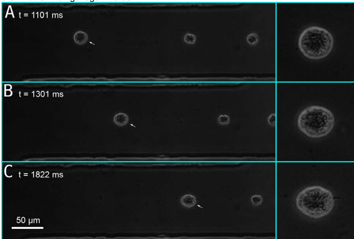
Abb. 5: Deformation einer Zelle im IFOS. Die angegebenen Zeiten beziehen sich auf den Moment, in dem die Zelle in die Messkammer eintritt.
