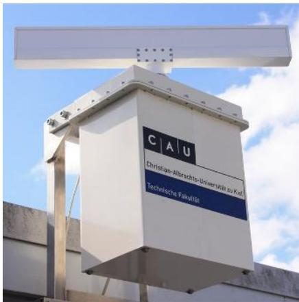
Im Nahbereich um ein Handelsschiff herum ist das Navigationsradar "blind". Um potentielle Angreifer auf kleinen, schnellen Booten nicht aus dem Blickfeld zu verlieren, war daher die Entwicklung eines Nahbereichsradars erforderlich. Hier wirkte RAN unterstützend zu den bei der Technischen Fakultät an der CAU angesiedelten Entwicklungen mit.
