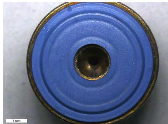
Abb. 5.4.1: links: Reibspuren im Verschluss an der Kontaktstelle zum Zylinderstift
