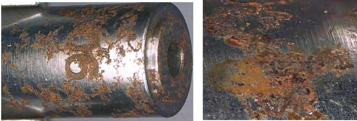
Abb. 4.1.3: Korrosionsspuren am Magnetanker nach Feuchtetest
