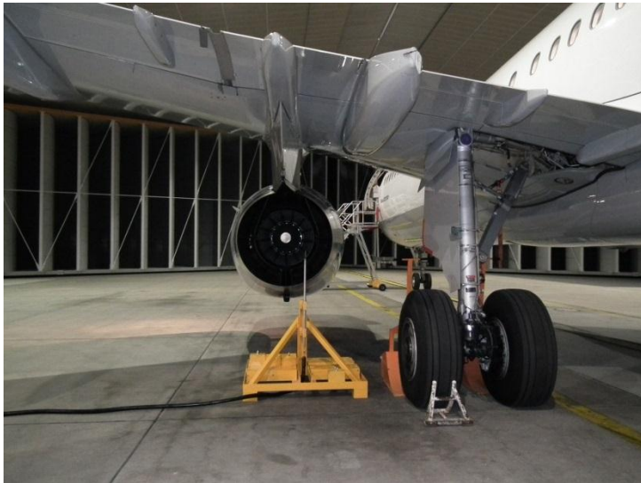
Abbildung 3.1: Sonde mit Sondenhalterung hinter dem Triebwerk
