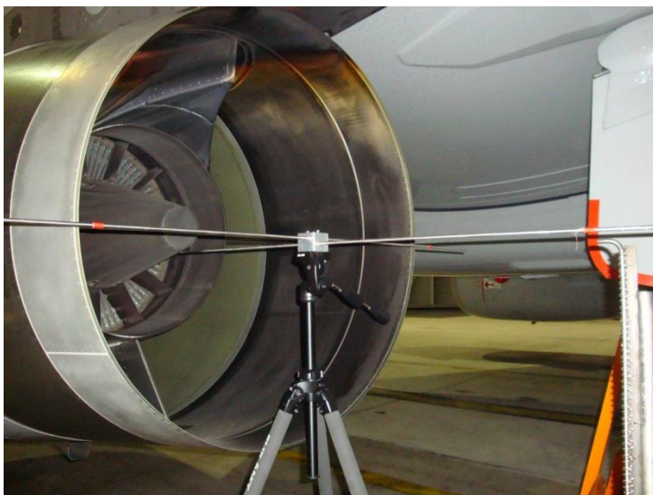
Abbildung 3.3: Positionierlehre zur Festlegung der Sondenposition
